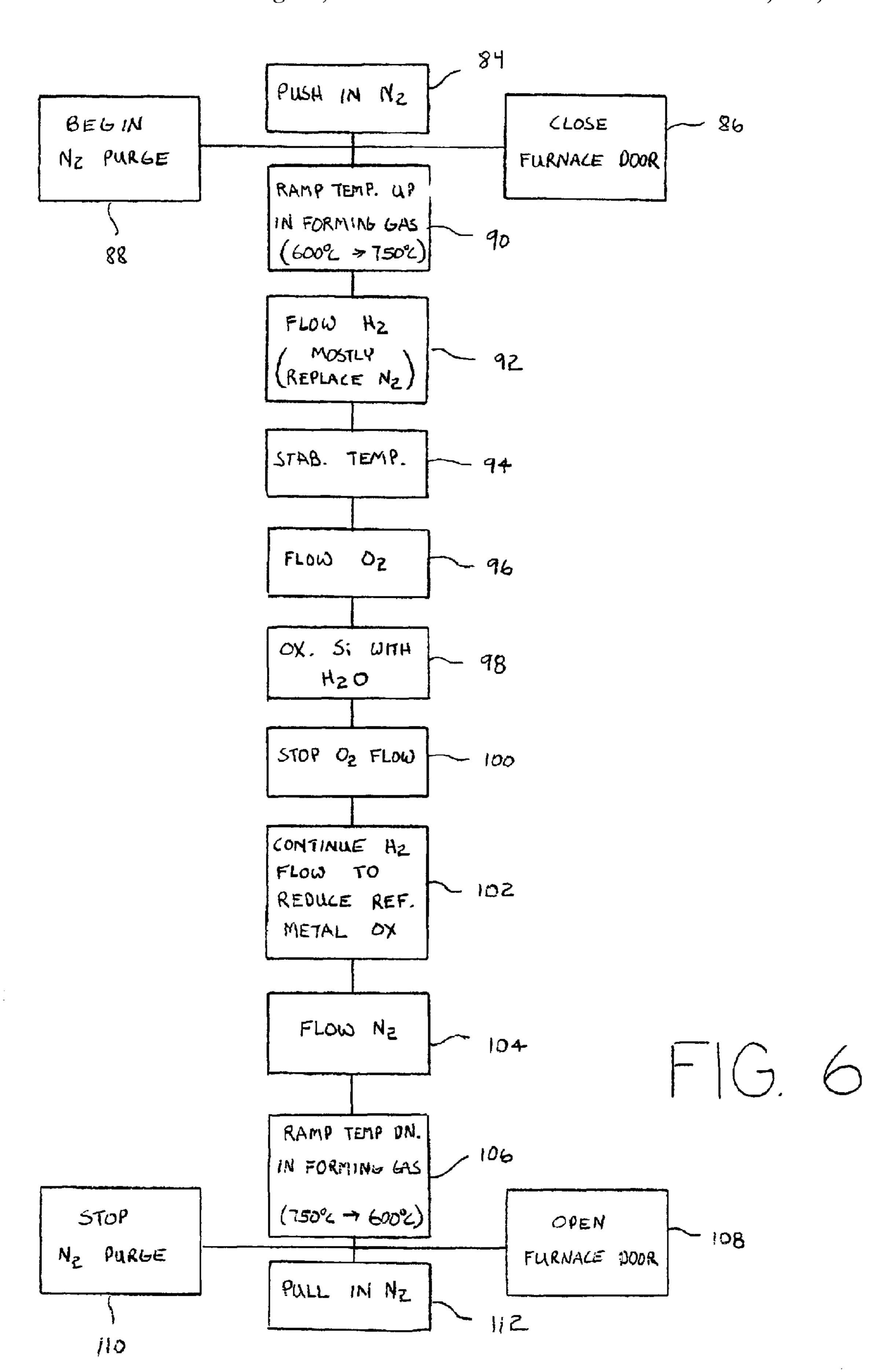
FURNACE SYSTEM AND METHOD FOR SELECTIVELY OXIDIZING A SIDEWALL SURFACE OF A GATE CONDUCTOR BY OXIDIZING A SILICON SIDEWALL IN LIEU OF A REFRACTORY METAL SIDEWALL
