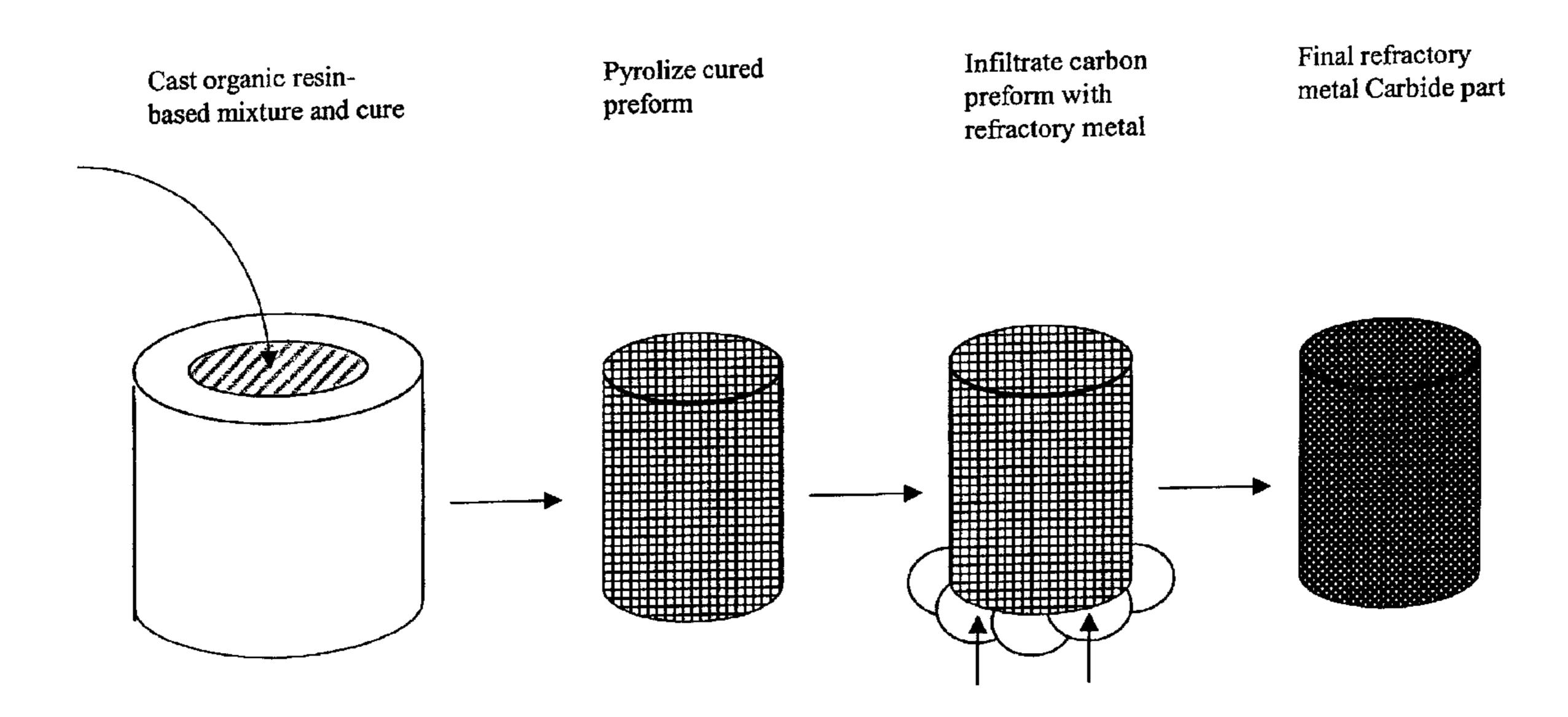
2000年间1. 经基本股份的股份的现代的基础的特殊的现在分词的现代形式。 Infiltrate preform preform and resin based mixture Cast orga
