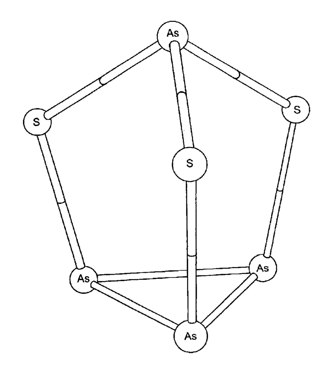
FIG. 1 As<sub>4</sub>S<sub>3</sub> MOLECULAR CLUSTER
