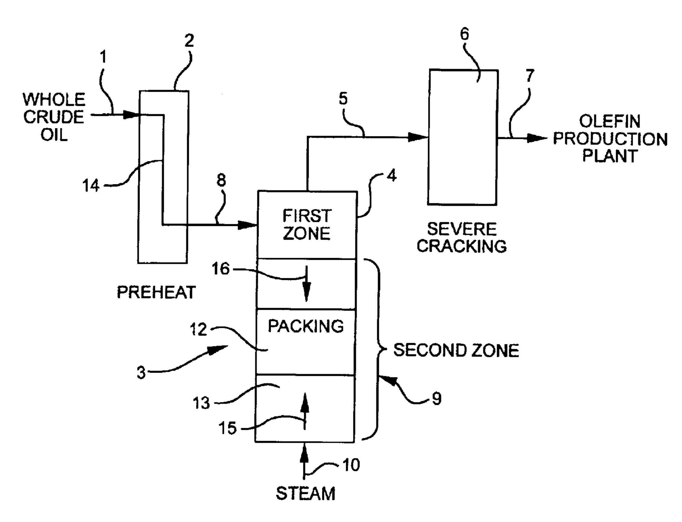
VAPORIZATION / MILD CRACKING
