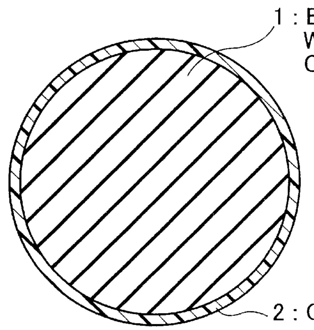
: BALL BODY MADE FROM WHITE RUBBER COMPOSITION CONTAINING TiO2 AND BLUE PIGMENT
