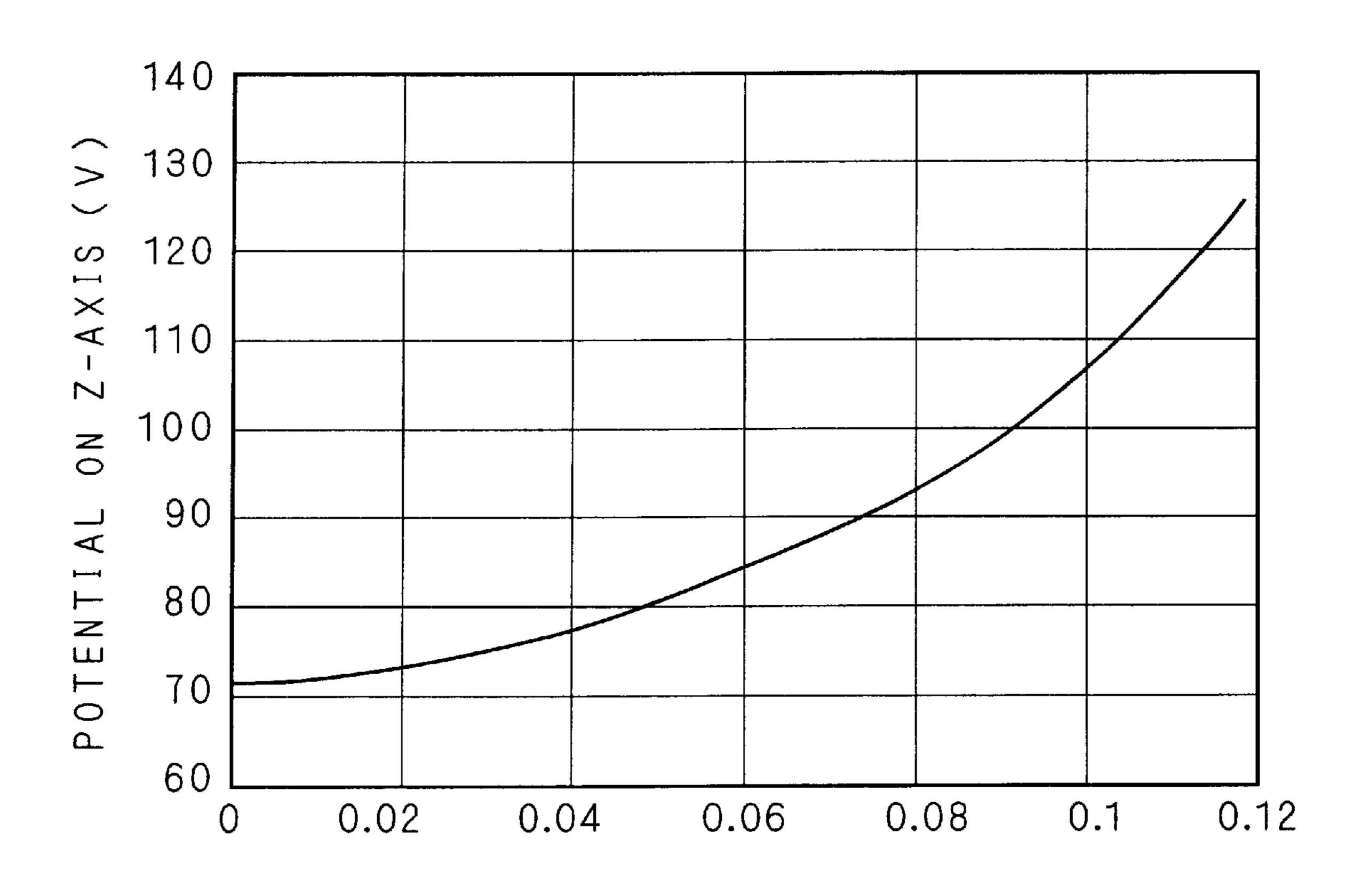
Z-AXIS POSITION FROM CATHODE FACE (mm)
