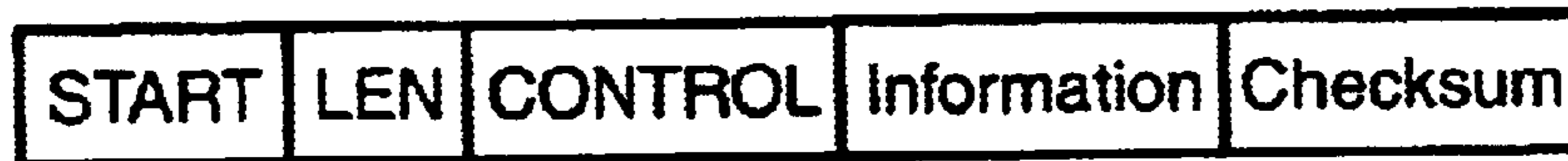
FIG. 5 - Non Network Mode Frame Format
