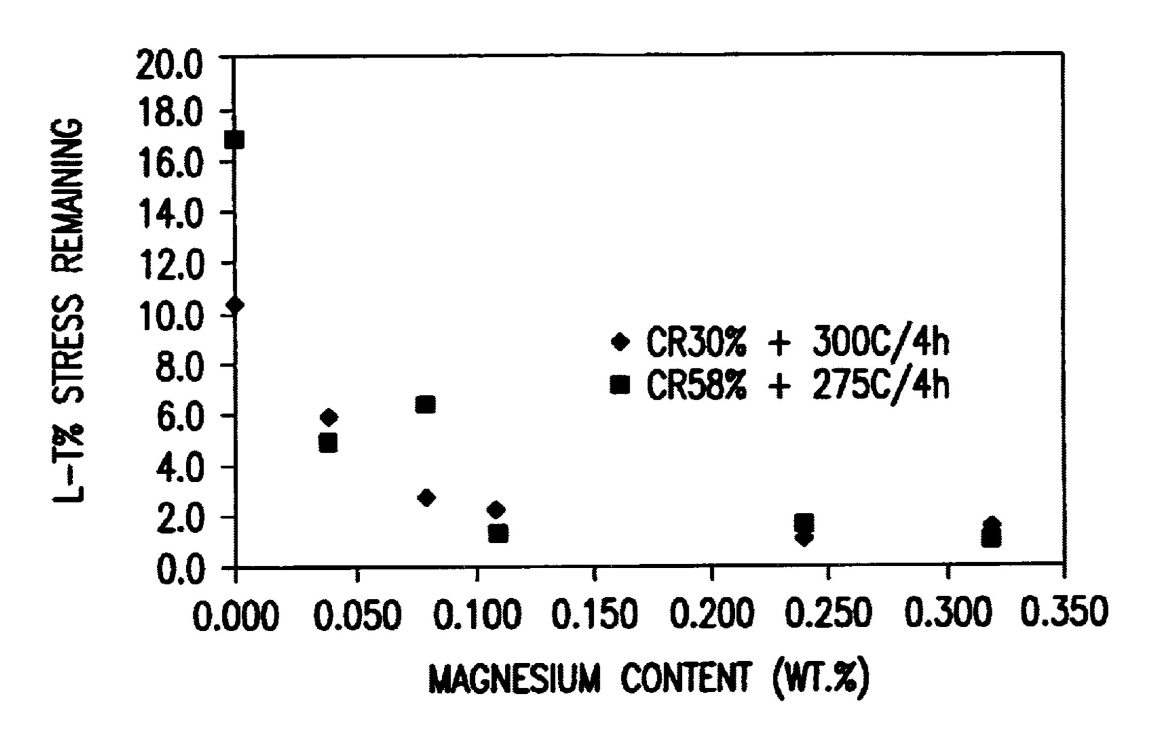
DIFFERENCE BETWEEN LONGITUDINAL (L) AND TRANSVERSE (T) RELAXATION AFTER 3000 HOURS AT 105°C TEST TEMPERATURE.
