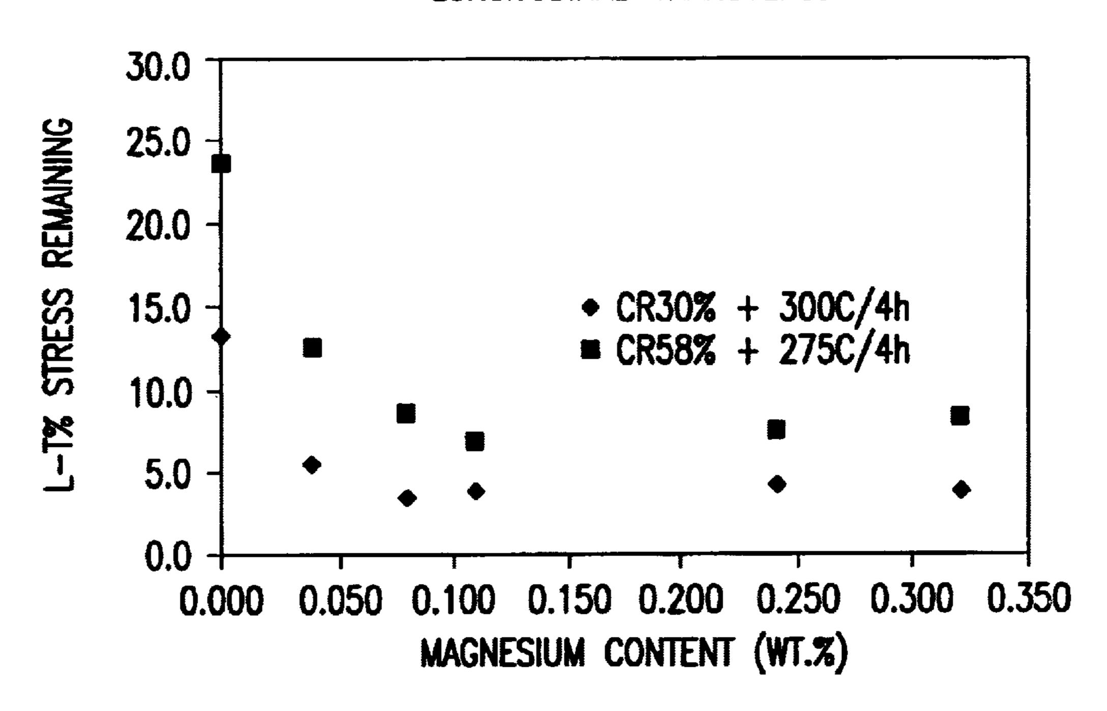
DIFFERENCE BETWEEN LONGITUDINAL (L) AND TRANSVERSE (T) RELAXATION AFTER 3000 HOURS AT 150°C TEST TEMPERATURE.
