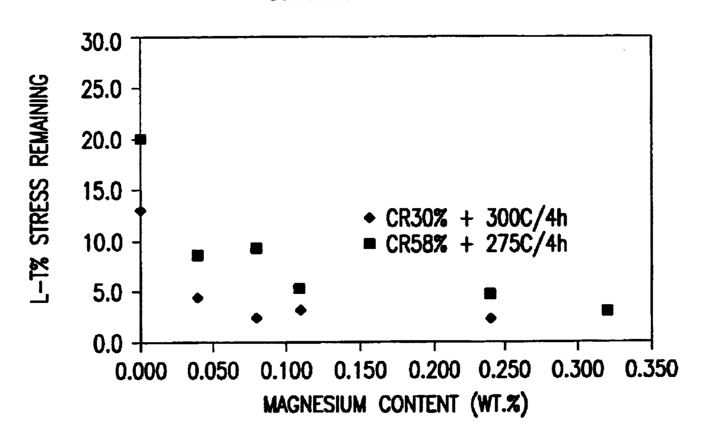
DIFFERENCE BETWEEN LONGITUDINAL (L) AND TRANSVERSE (T) RELAXATION AFTER 3000 HOURS AT 125°C TEST TEMPERATURE.
