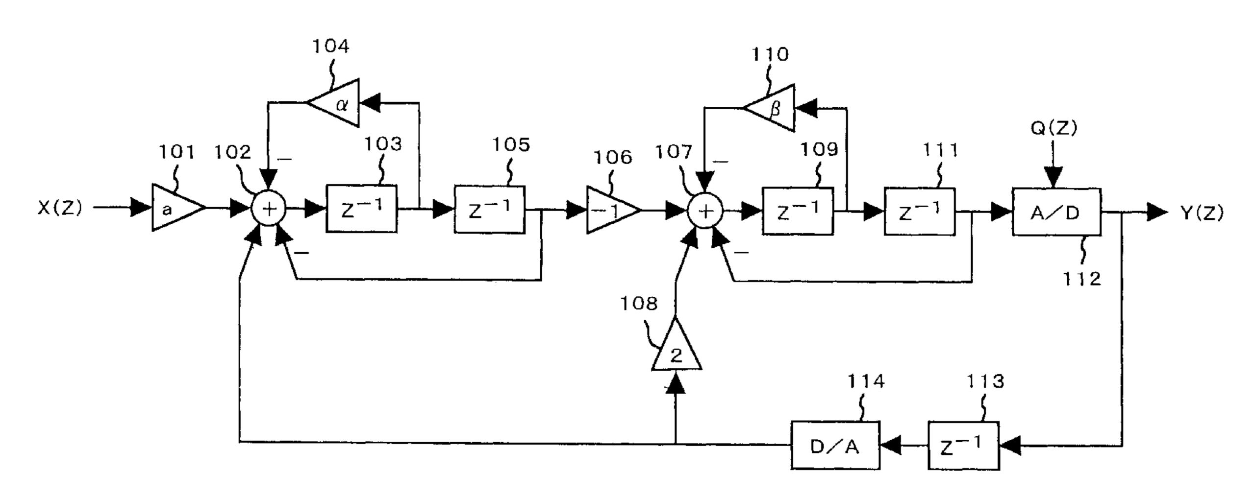
$H(Z) = -aX(Z)Z^{-4} + (1 + \alpha Z^{-1} + Z^{-2})(1 + \beta Z^{-1} + Z^{-2})Q(Z)$
