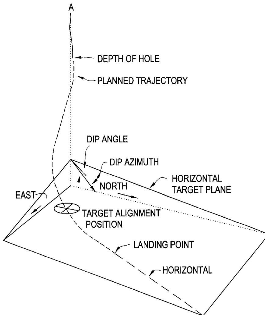
**PLANNED TRAJECTORY FOR A HORIZONTAL TARGET**
