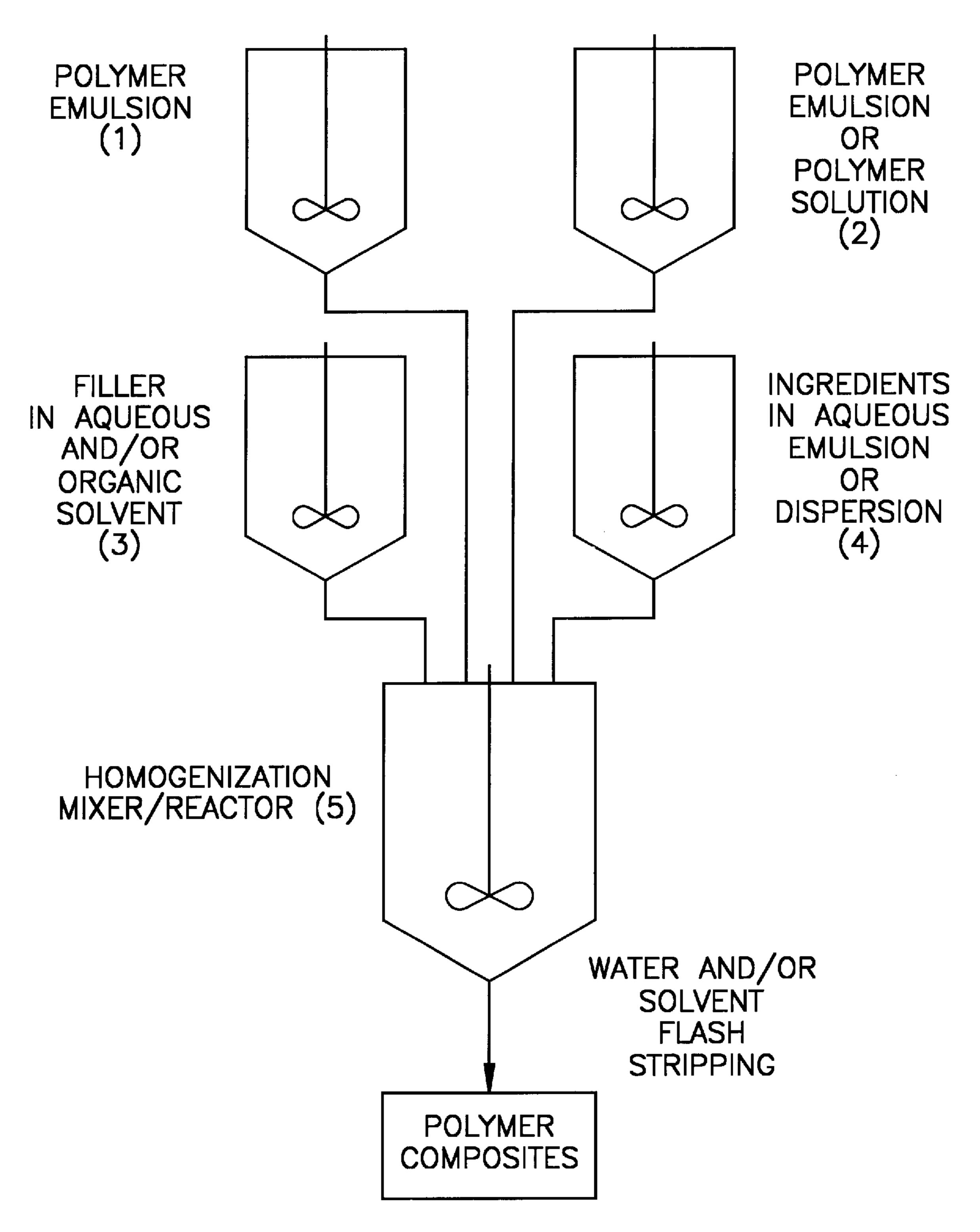
POLYMER COMPOSITES FROM AQUEOUS EMULSION/DISPERSION MIXING FIG-1
