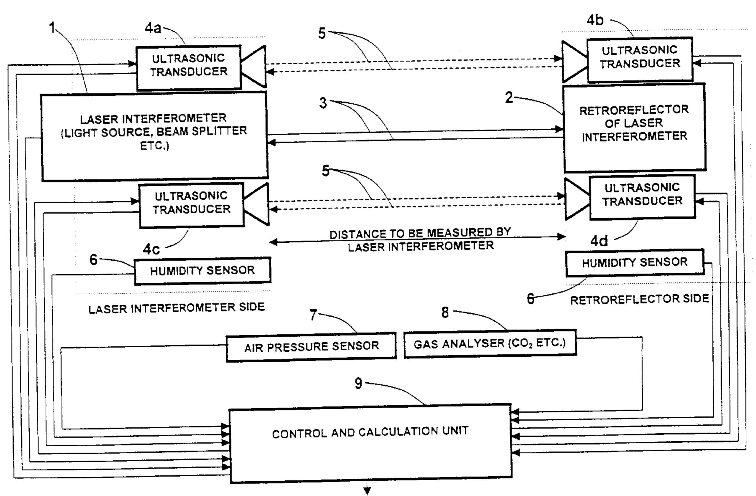
CORRECTION FOR DISTANCE MEASURED BY LASER INTERFEROMETER
