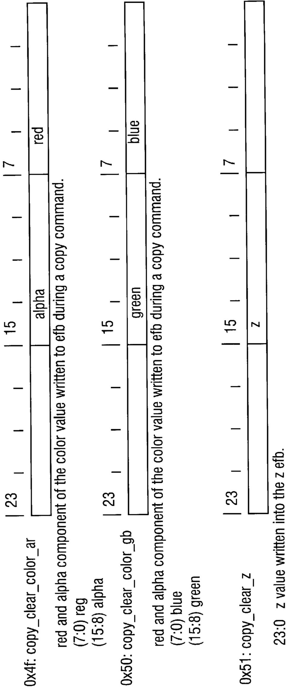
Fig. 9a EXAMPLE PIXEL ENGINE COPY CLEAR REGISTER FORMATS
