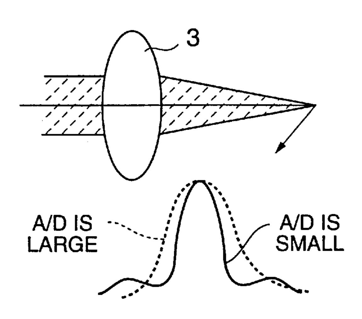
LIGHT INTENSITY DISTRIBUTION OF BEAM SPOT ON IMAGE SURFACE
