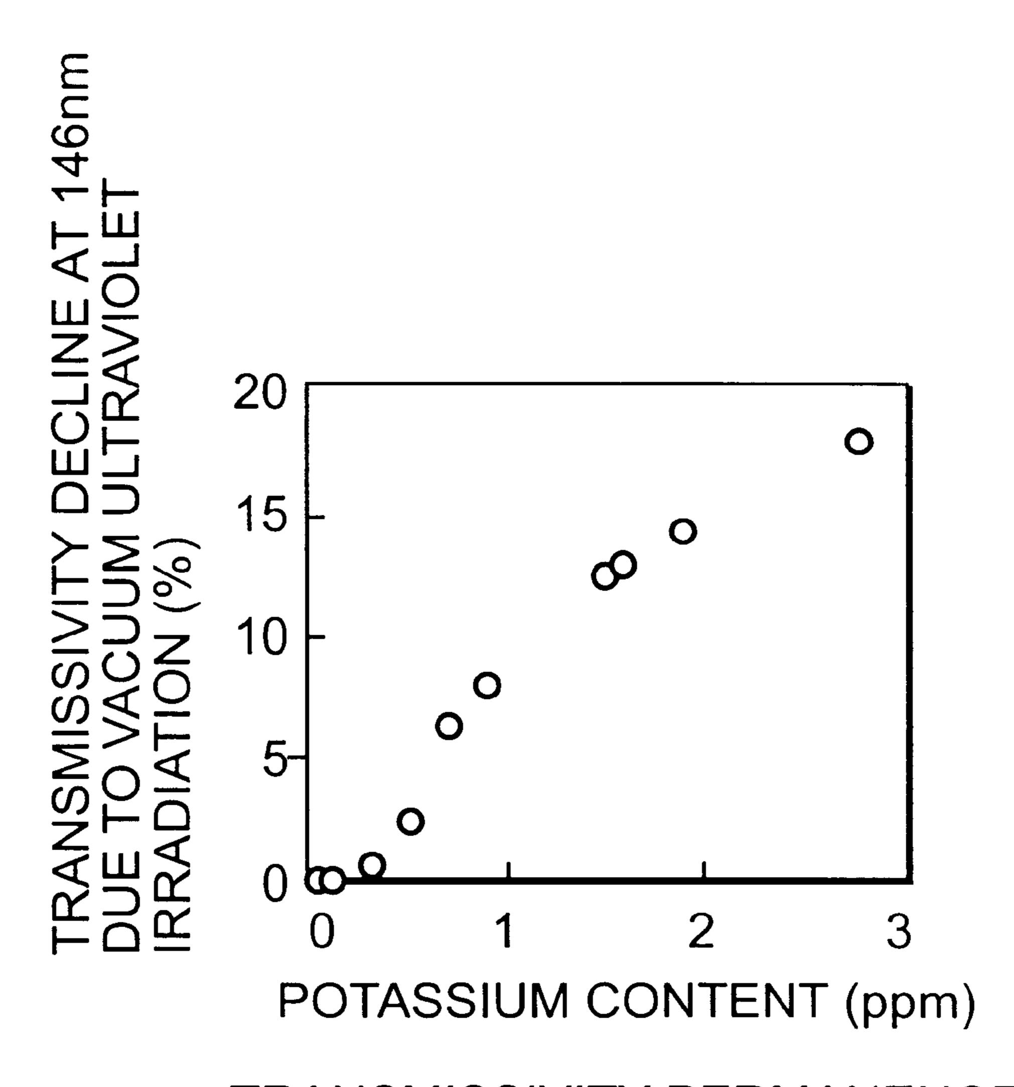
TRANSMISSIVITY PERMANENCE VERSUS POTASSIUM CONTENT
