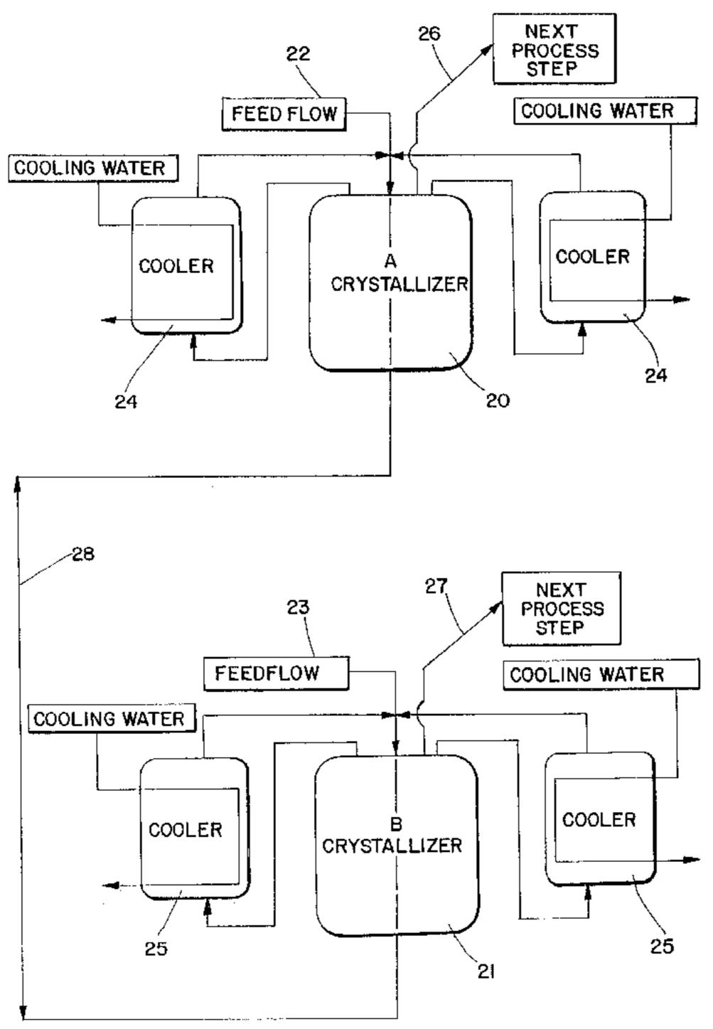
SLURRY FEED FROM B CRYSTALLIZER TO A CRYSTALLIZER AND VICE VERSA
