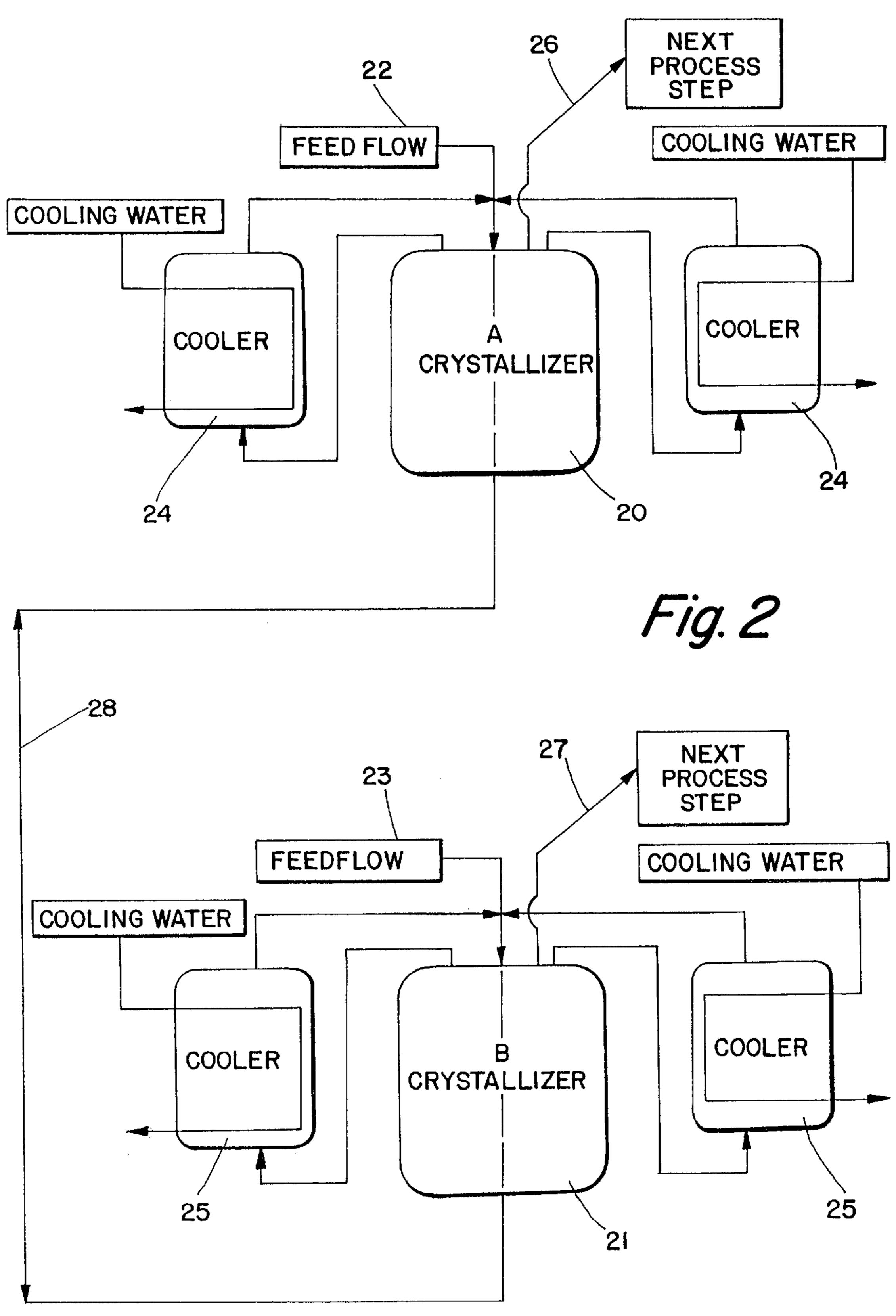
SLURRY FEED FROM B CRYSTALLIZER TO A CRYSTALLIZER AND VICE VERSA
