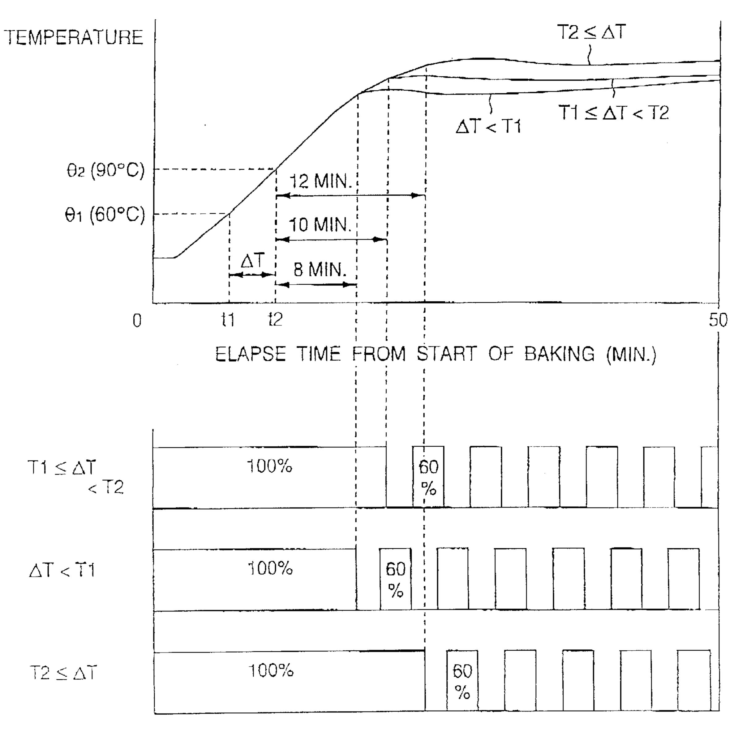
ENERGIZATION DUTY IN BAKING STEP
