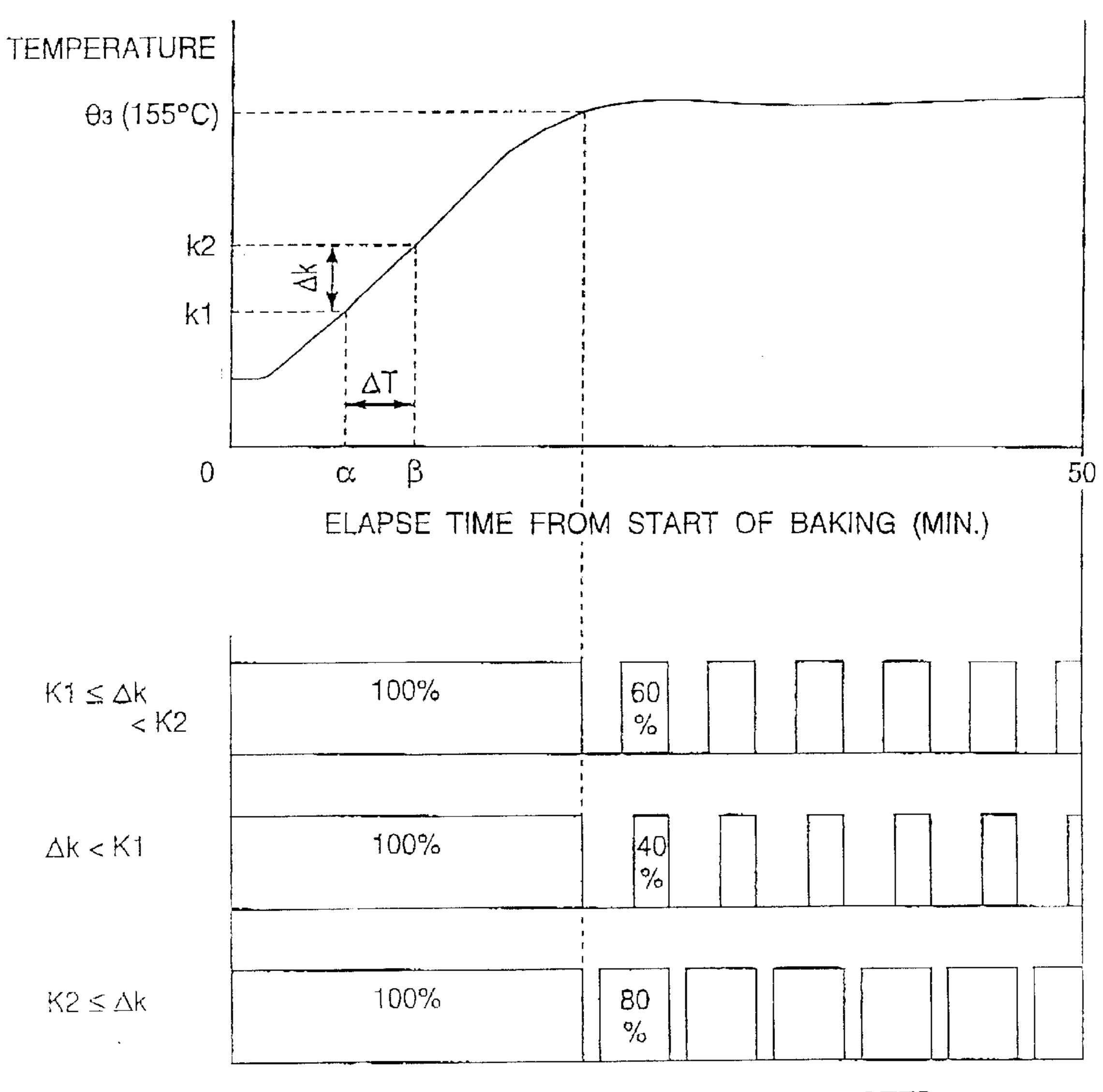
ENERGIZATION DUTY IN BAKING STEP
