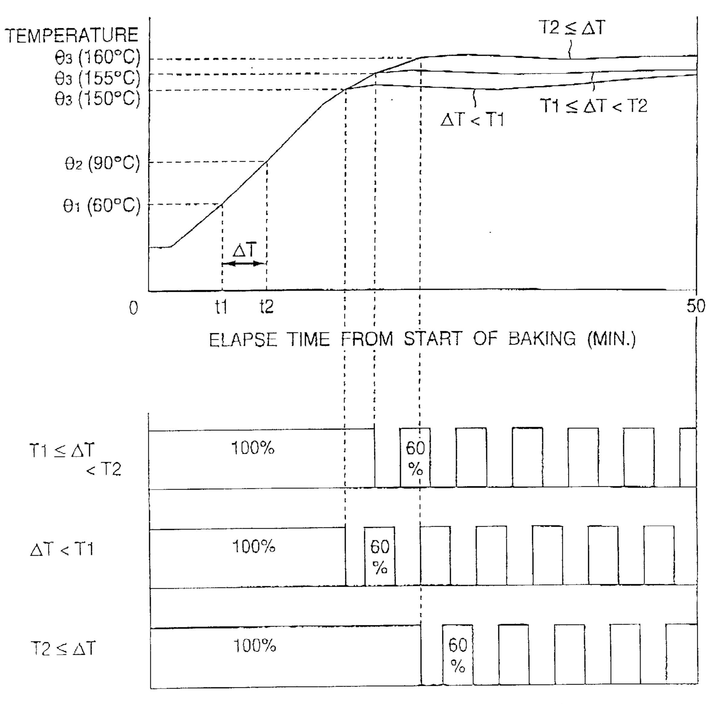
ENERGIZATION DUTY IN BAKING STEP
