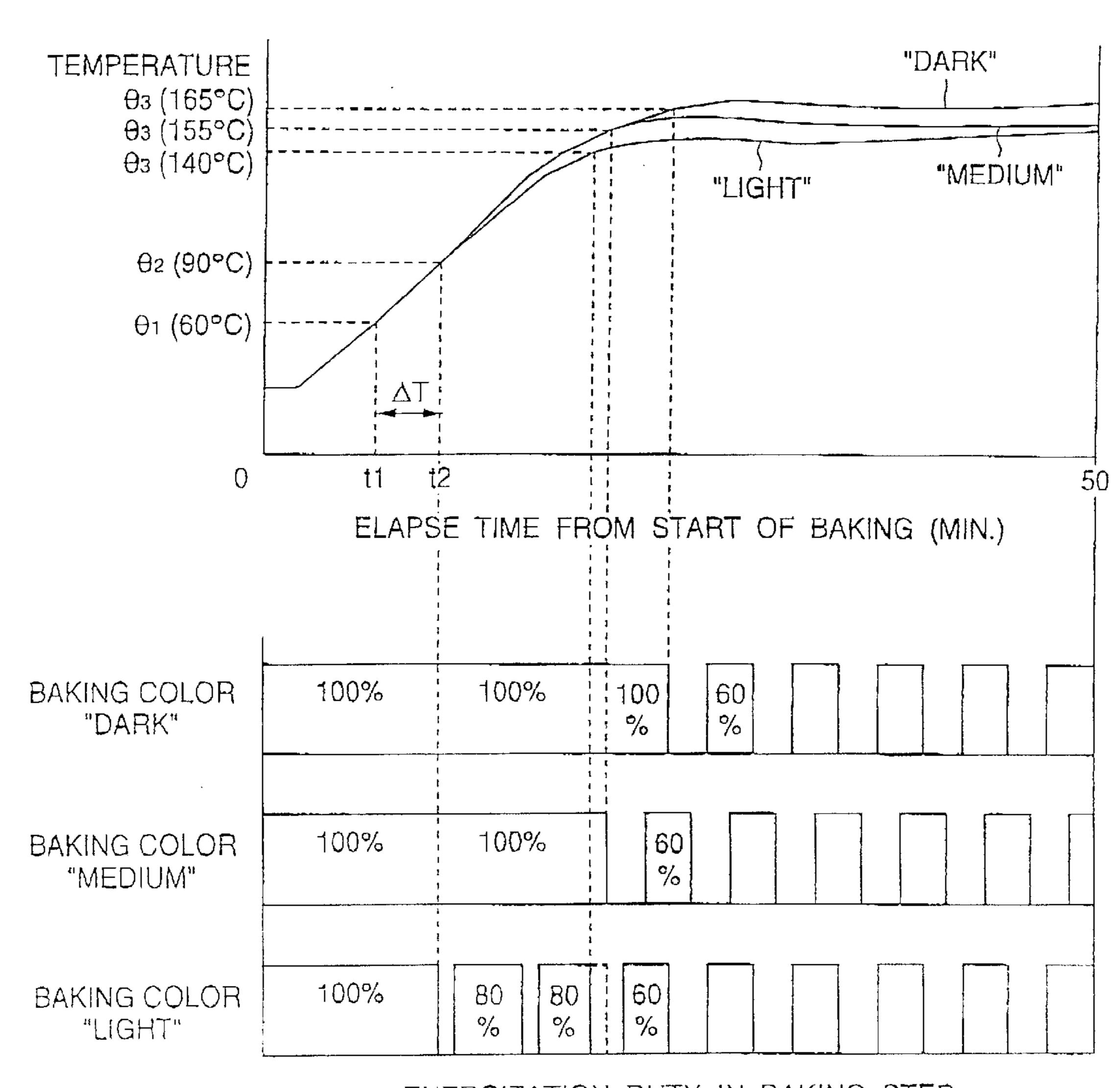
ENERGIZATION DUTY IN BAKING STEP
