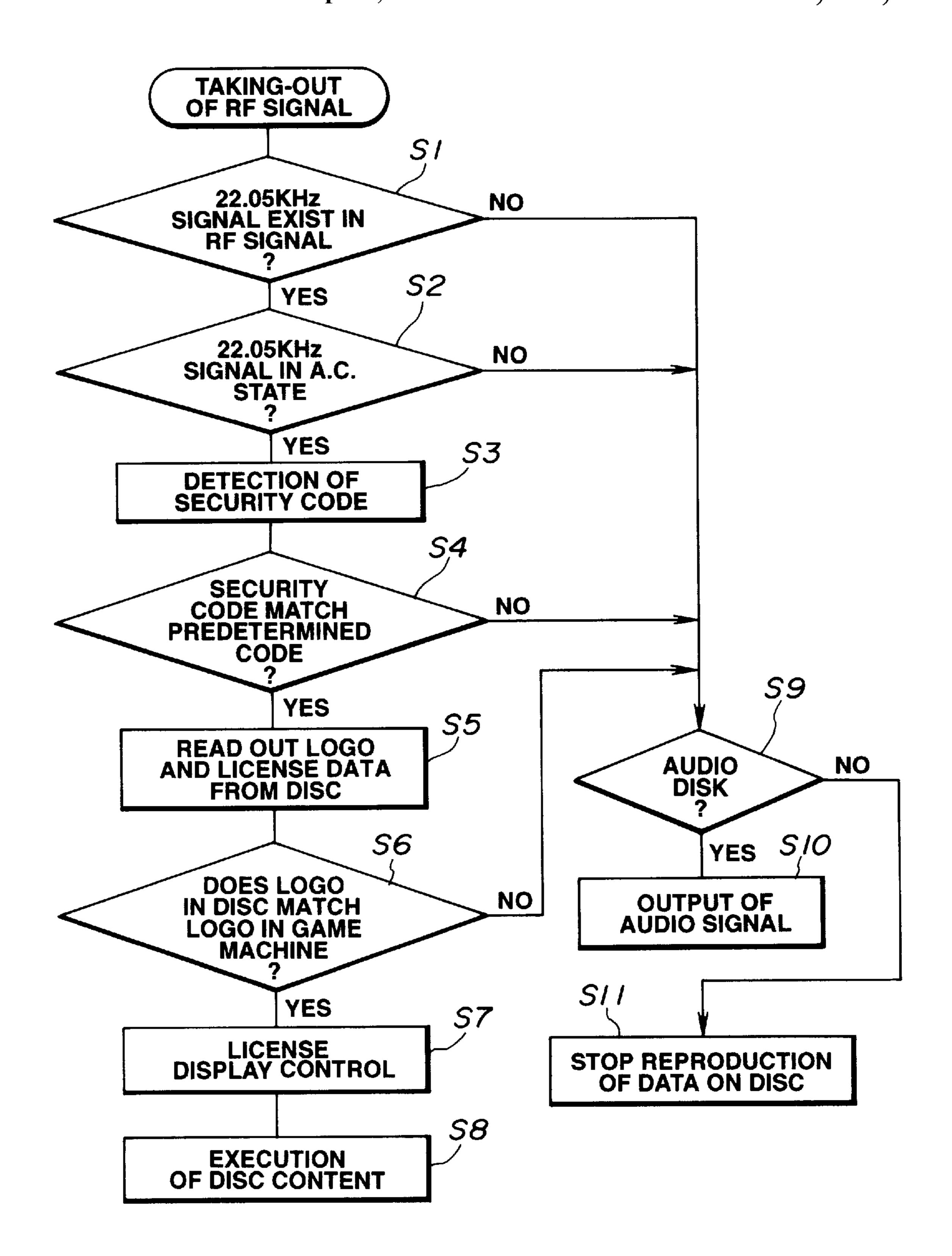
FLOW DIAGRAM OF SYSTEM OPERATION
