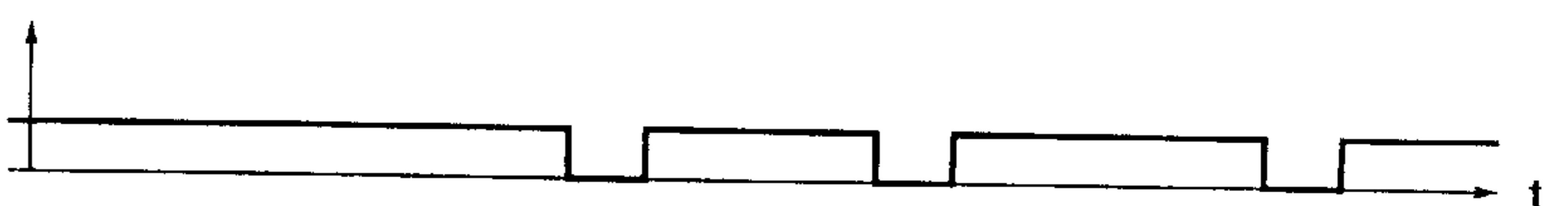
FIG. 6J MONITOR CURRENT i_m ( i_0 - (i_1 + i_2 + i_3) )
