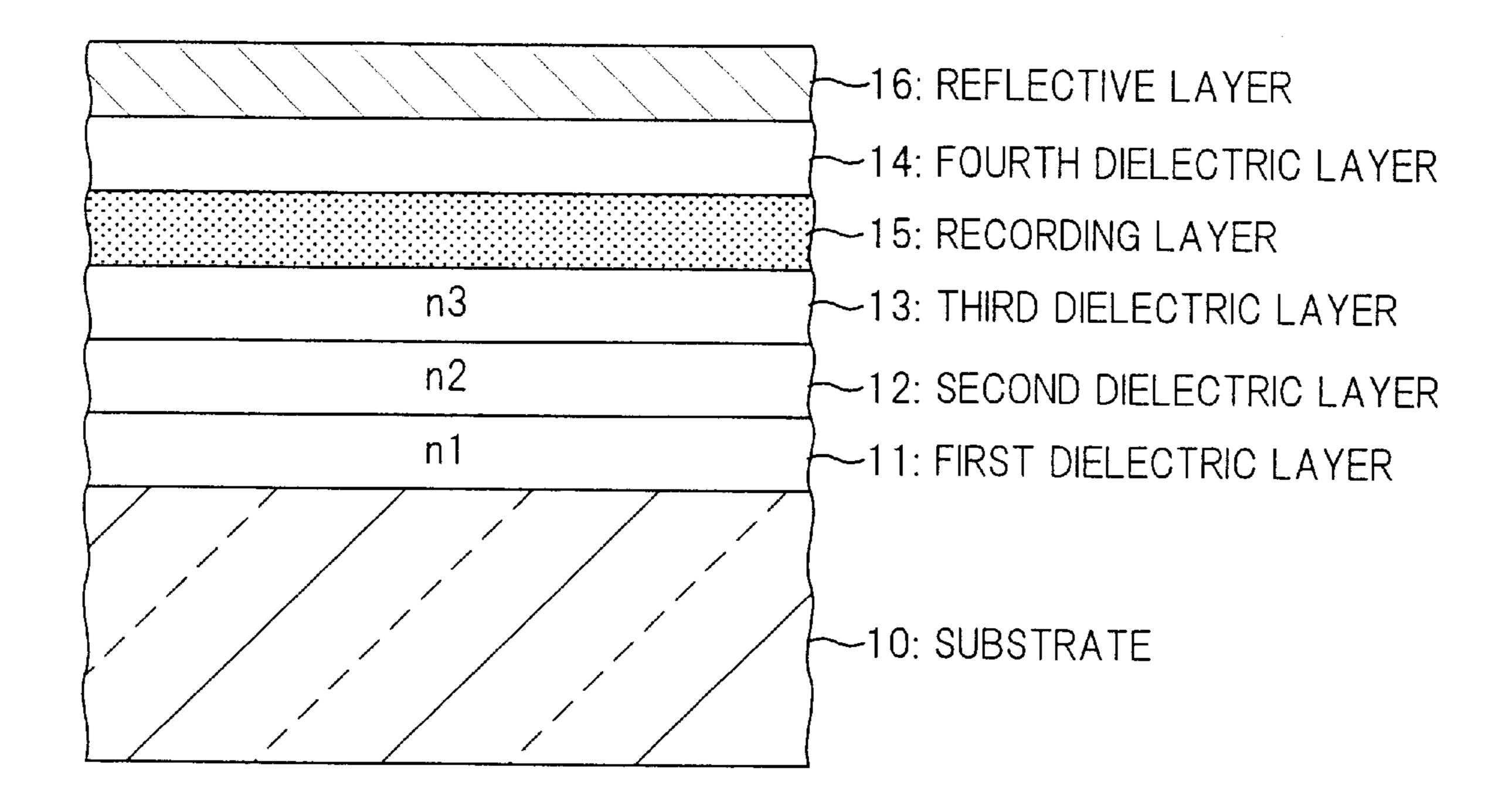
n1: REFRACTIVE INDEX OF FIRST DIELECTRIC LAYER n2: REFRACTIVE INDEX OF SECOND DIELECTRIC LAYER
