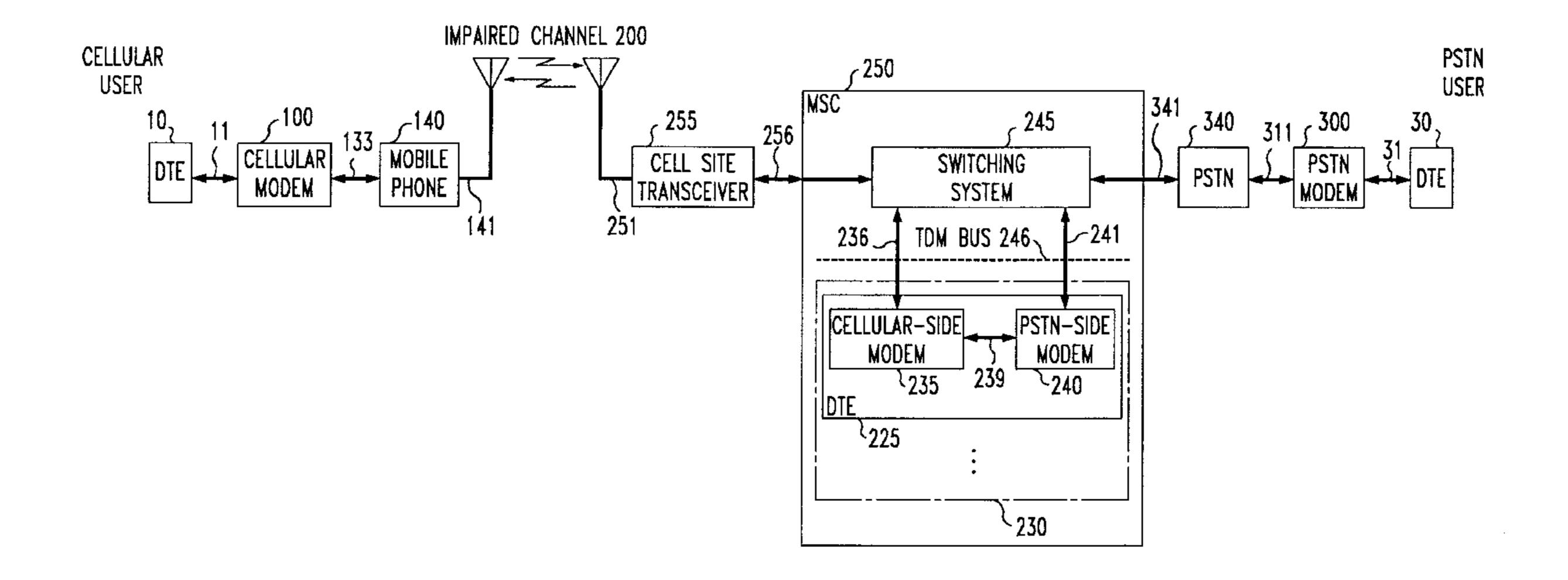
PSTN USER **₩**~ 300 311 340  $\Sigma$ PSTN-SIDE MODEM 7240 245 230 246 **SWITCHING** SYSTEM 239 BUS . . . CELLULAR-SIDE MODEM \235 TDM 1225 250 236 256 **TRANSCEIVER** CELL SITE 255 200 CHANNEL IMPAIRED MOBILE PHONE -140 CELLULAR MODEM 1000 CELLULAR USER
