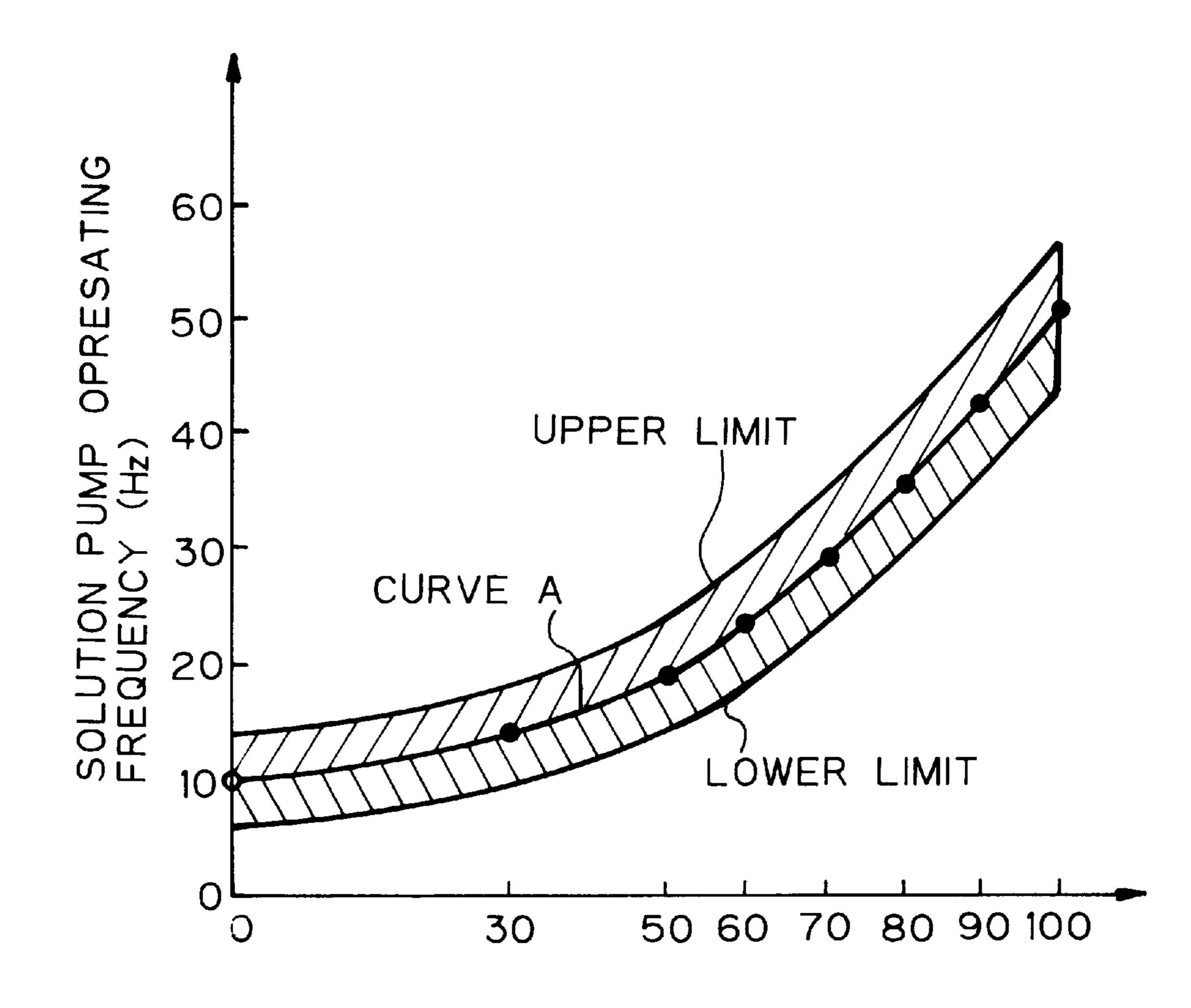
REFRIGERANT VAPOR SATURATION TEMPERATURE IN HIGH-TEMPERATURE GENERATOR (°C)
