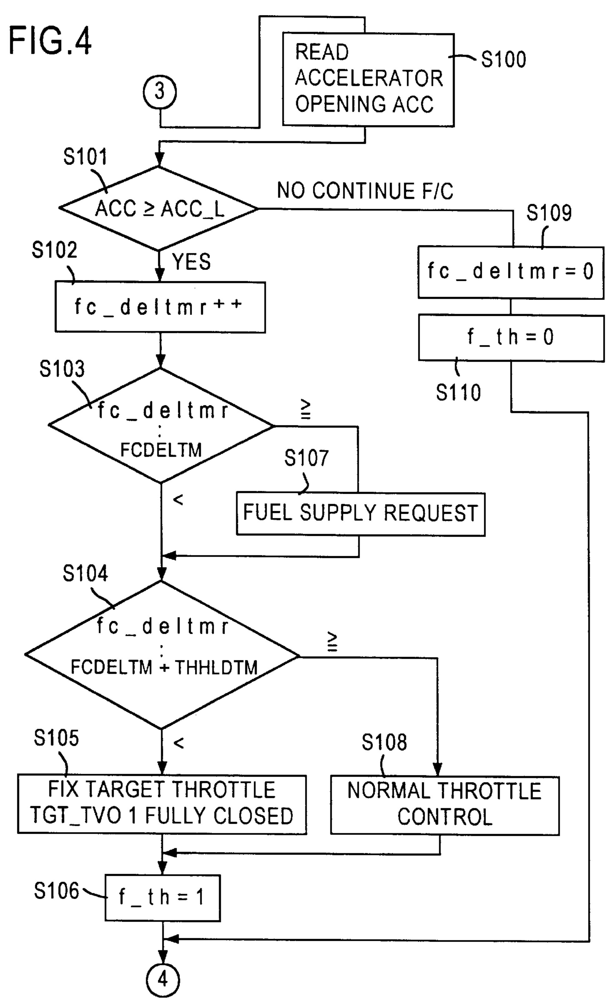
TVO-L: FUEL CUT OFF RELEASE TVO fc\_deltmr: FUEL CUT OFF RELEASE DELAY TIME f\_th: THROTTLE CONTROL FLAG
