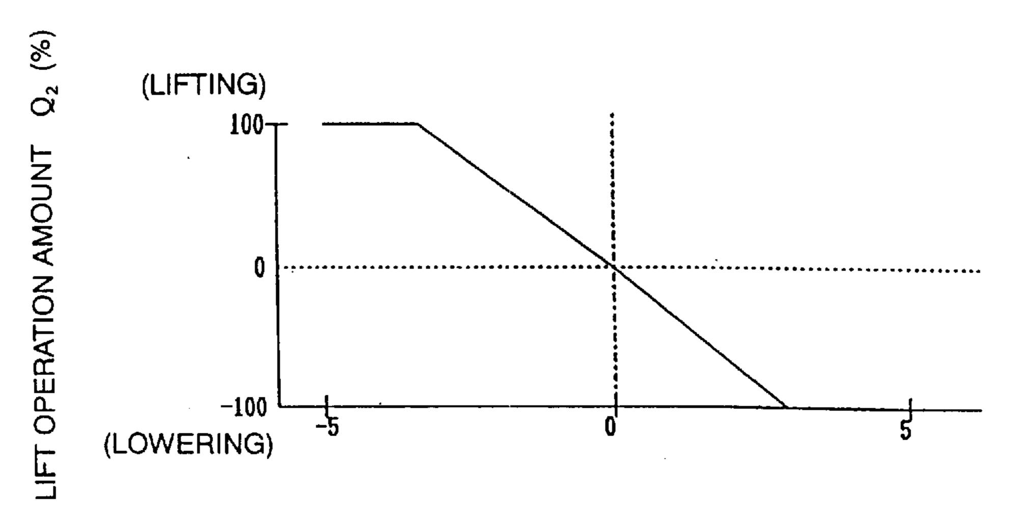
BLADE CUTTING EDGE POSITION DIFFERENCE  $\Delta \, \psi$  (° )
