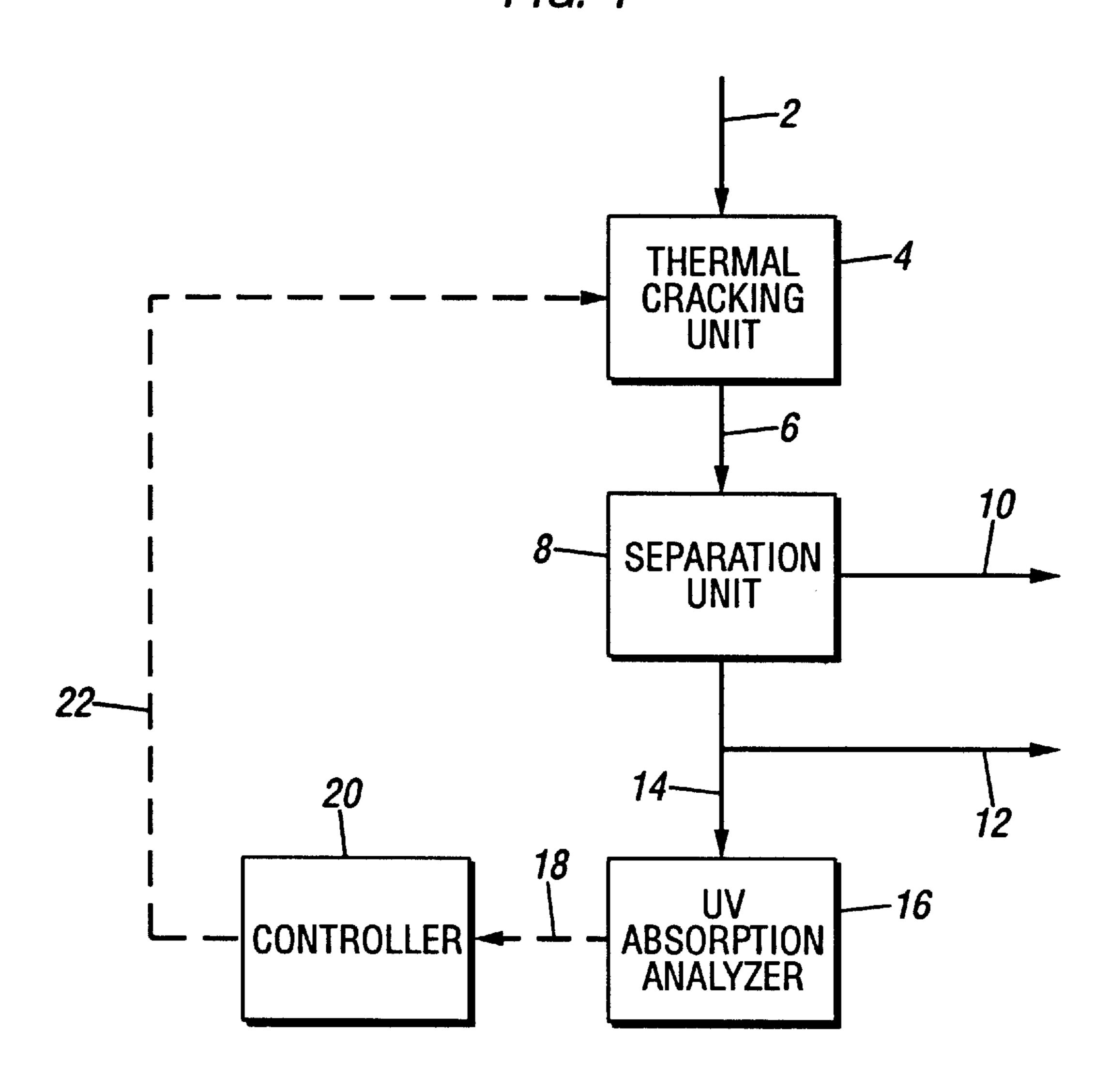
FIG. 2 ABSORPTION ANALYZER THERMAL CRACKING UNIT SEPARATION UNIT CONTROLLER ABSORPTION ANALYZER
