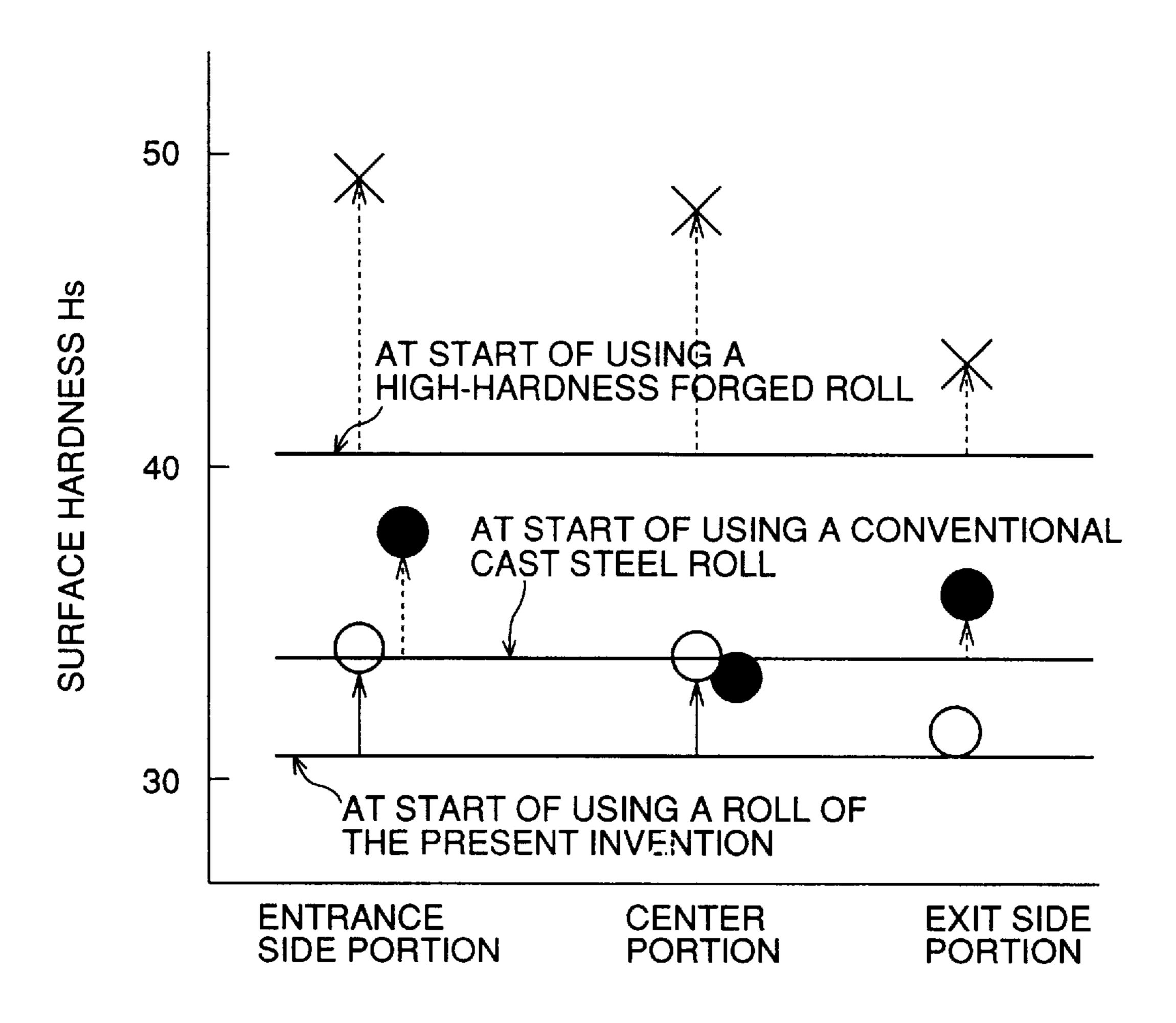
SYMBOLS X, ● and ○ DENOTE HARDNESS AFTER USING LINE — DENOTES HARDNESS BEFORE USING
