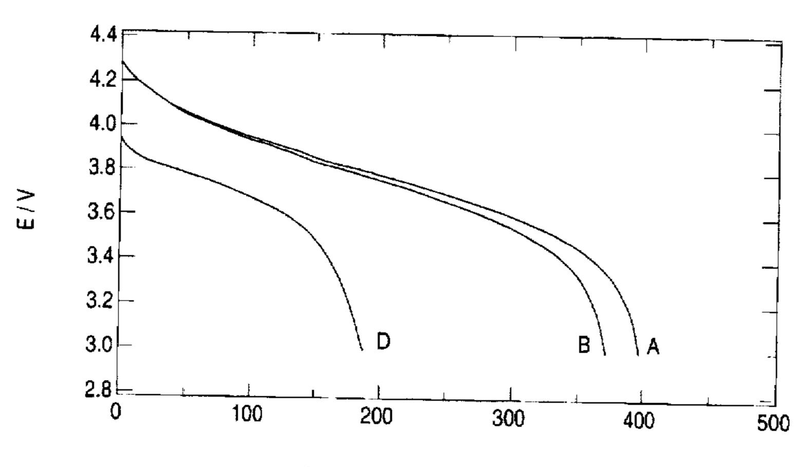
DISCHARGE CAPACITY / mAh
