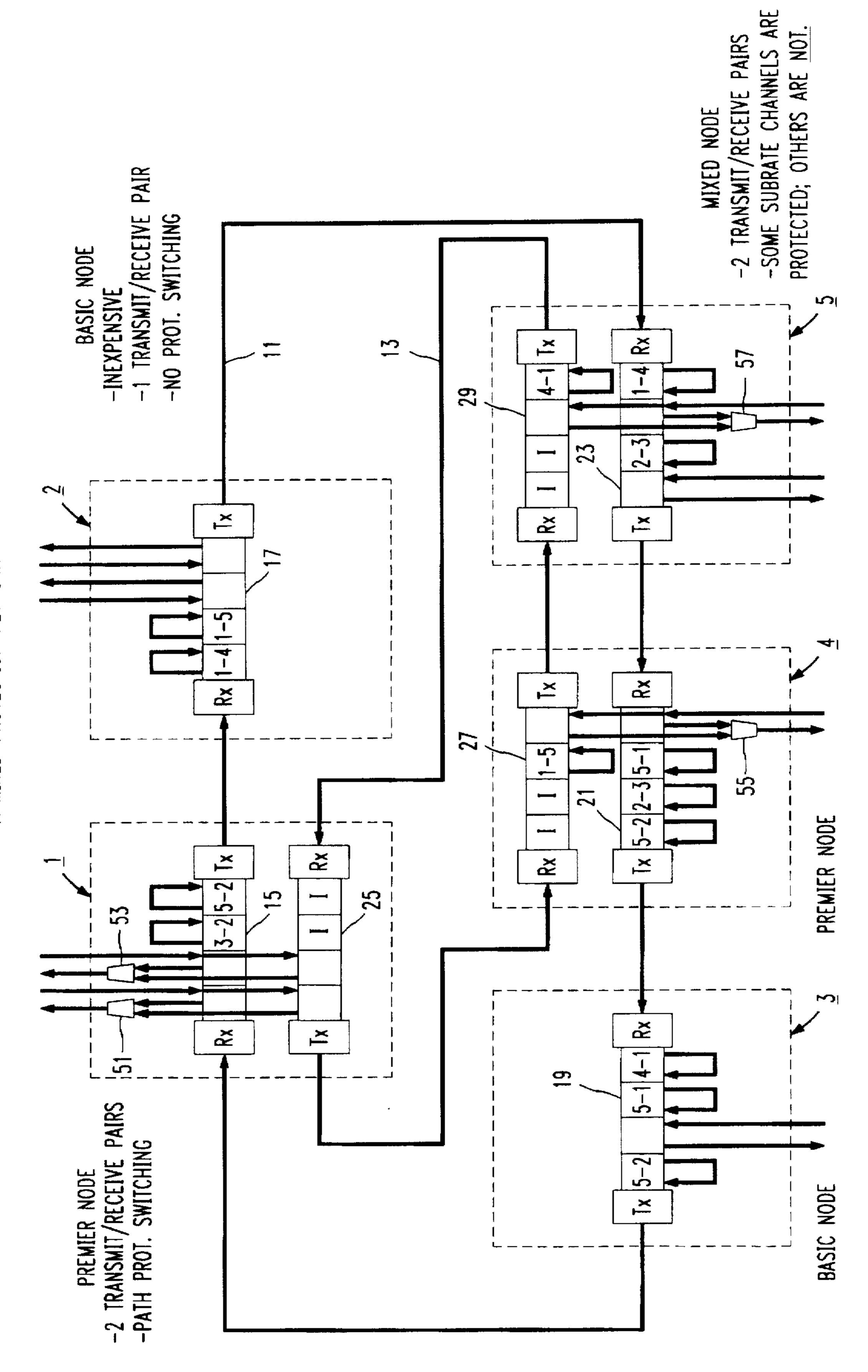
FIG. 2 SONET/SDH STANDARD RDI/AIS SIGNALING PRIOR ART
