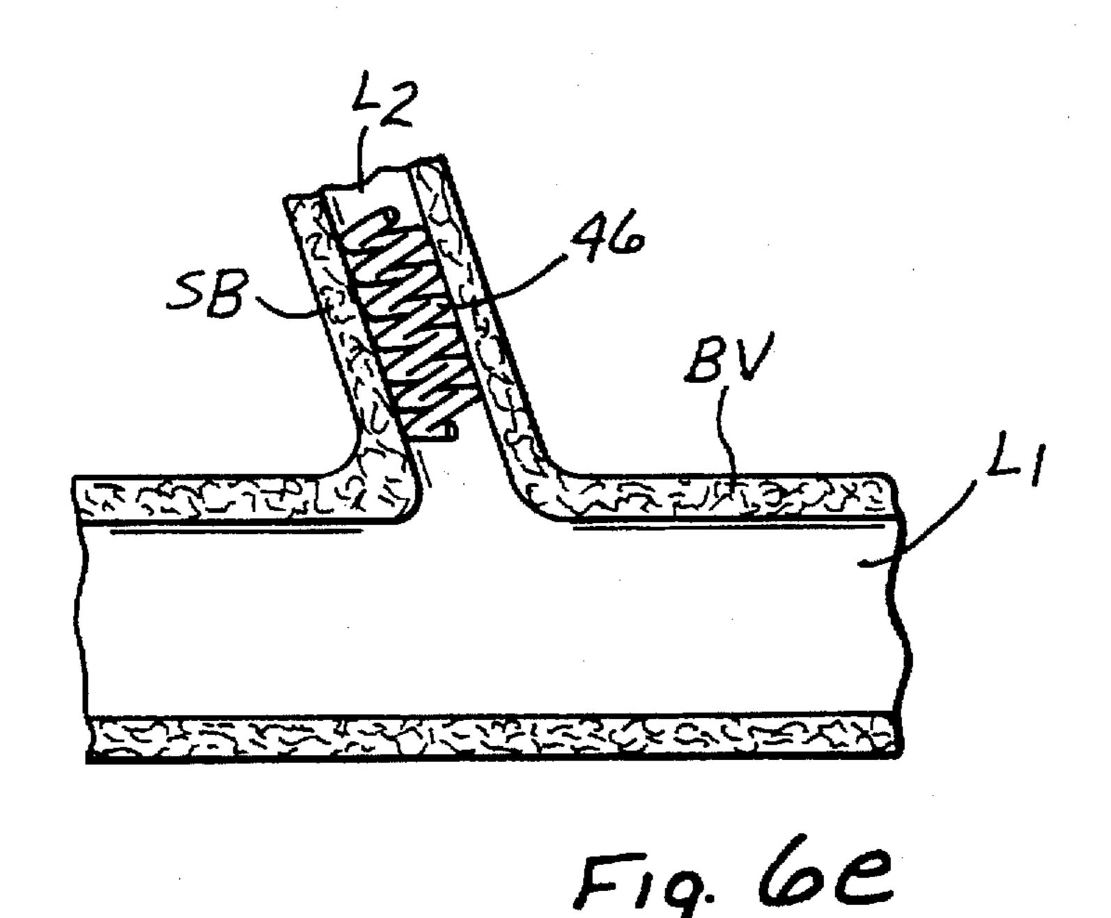
SIDE BRANCH OCCLUSION CATHETER
