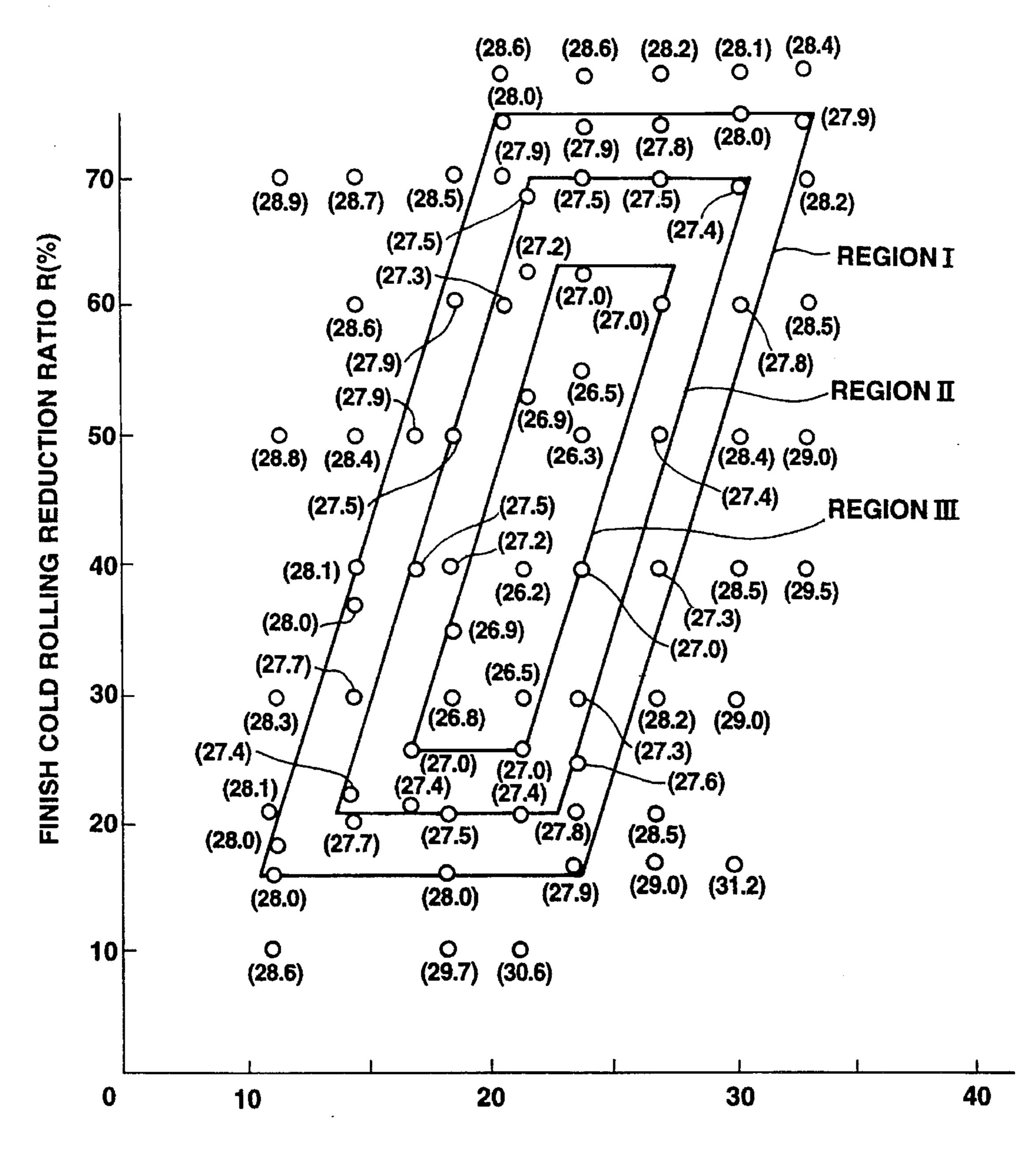
AUSTENITE GRAIN SIZE BEFORE FINISH COLD ROLLING D(µm)
