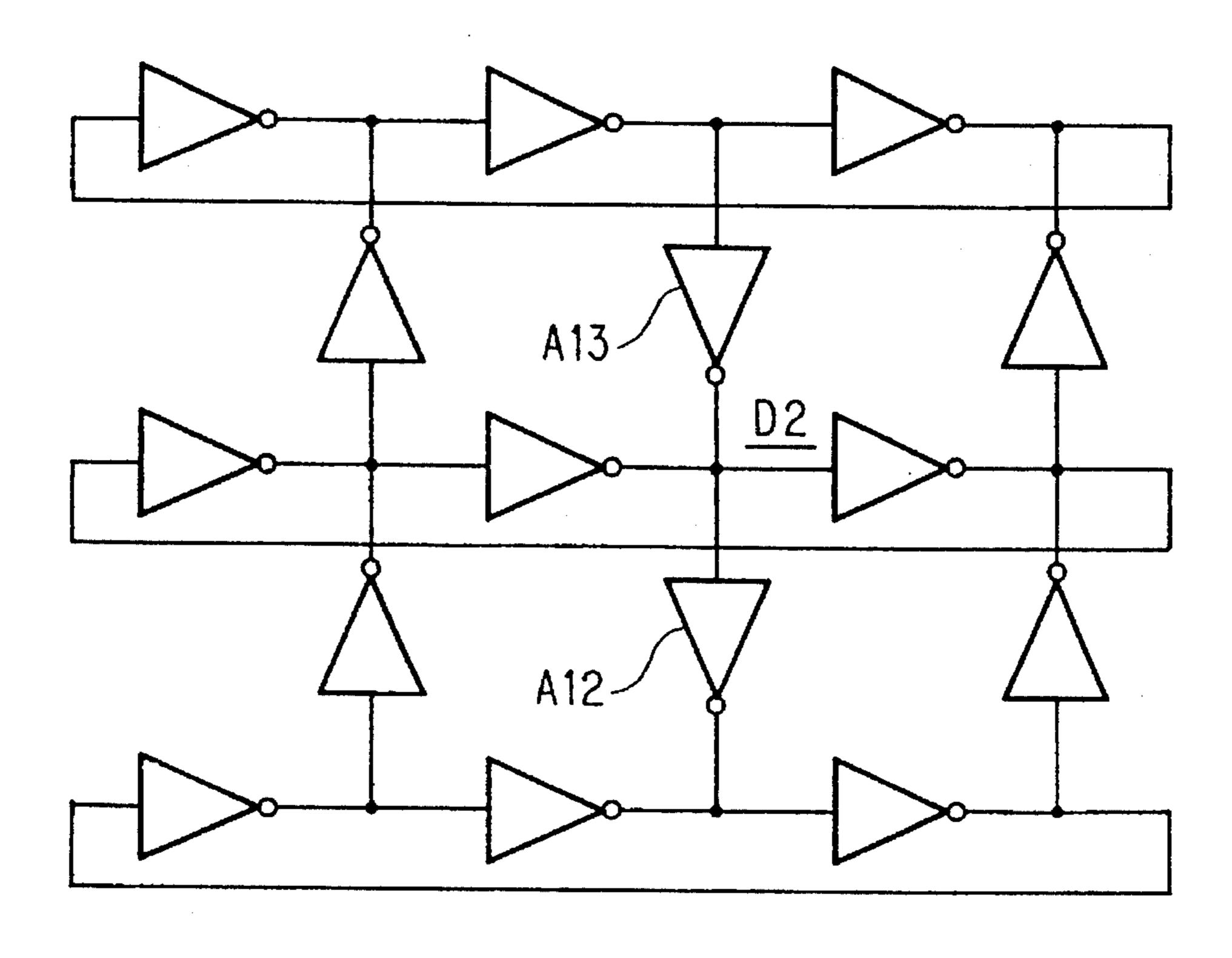
A12,13: AMPLIFIER ELEMENTS D2: DELAY UNITS
