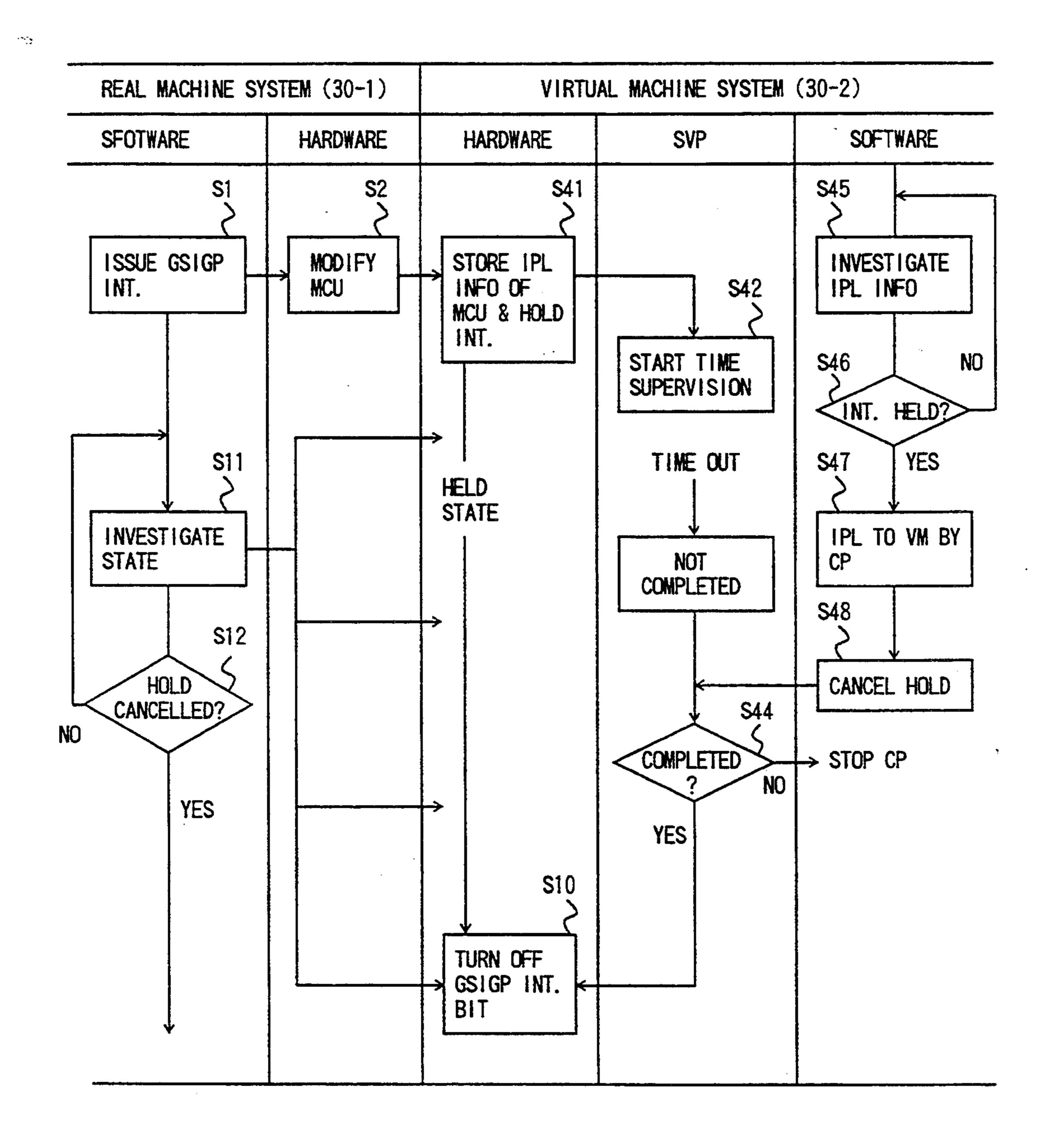
GLOBAL COMMUNICATION INTERRUPT CONTROL SYSTEM FOR COMMUNICATION BETWEEN REAL AND VIRTUAL MACHINE SYSTEMS USING GLOBAL COMMUNICATION FUNCTIONS OF A SHARED MEMORY
