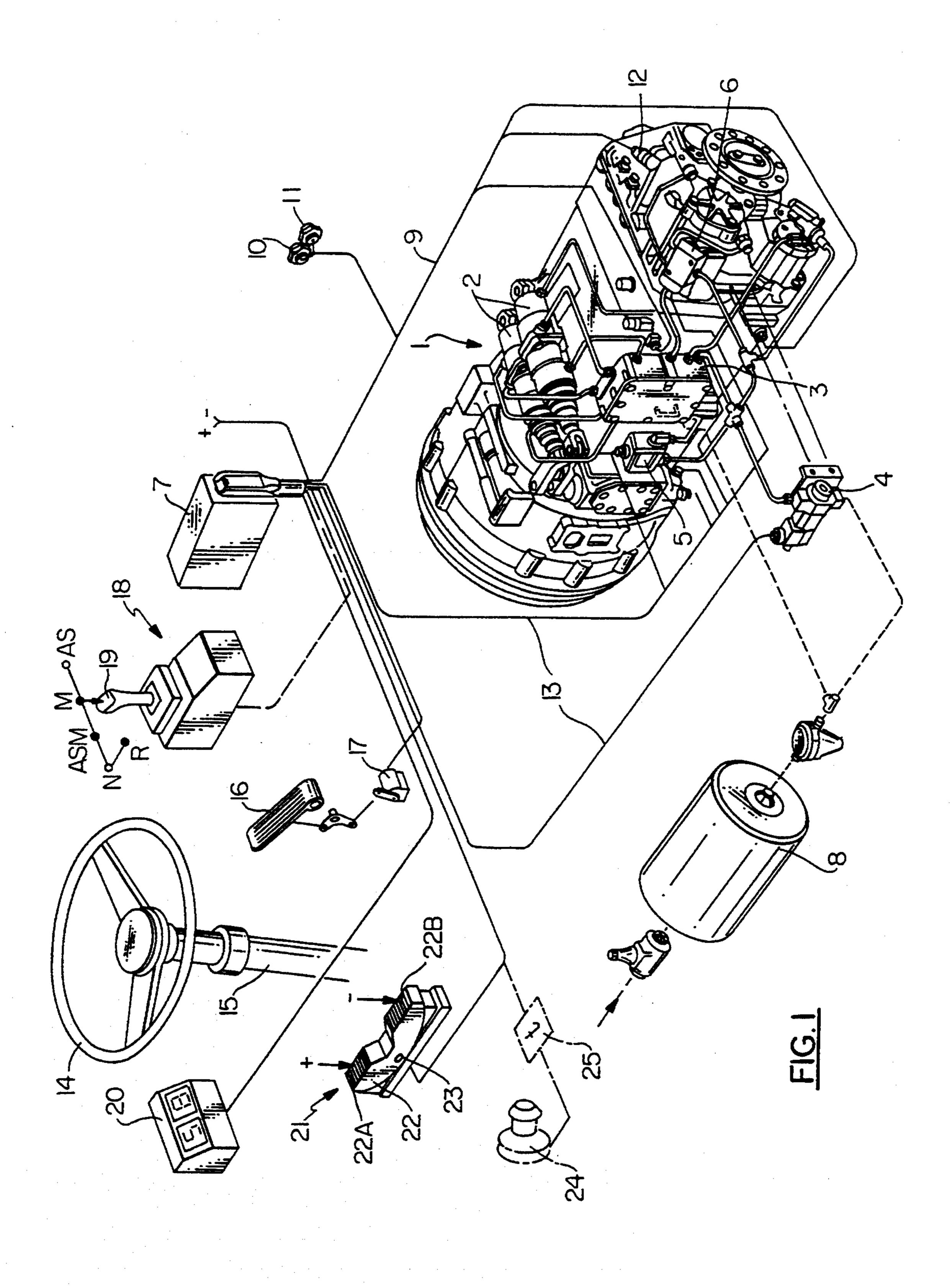
GEAR-SHIFT CONTROL AND GEAR-RANGE SELECTOR FOR A SEMI-AUTOMATIC OR FULLY-AUTOMATIC MOTION VEHICLE **GEARBOX**
