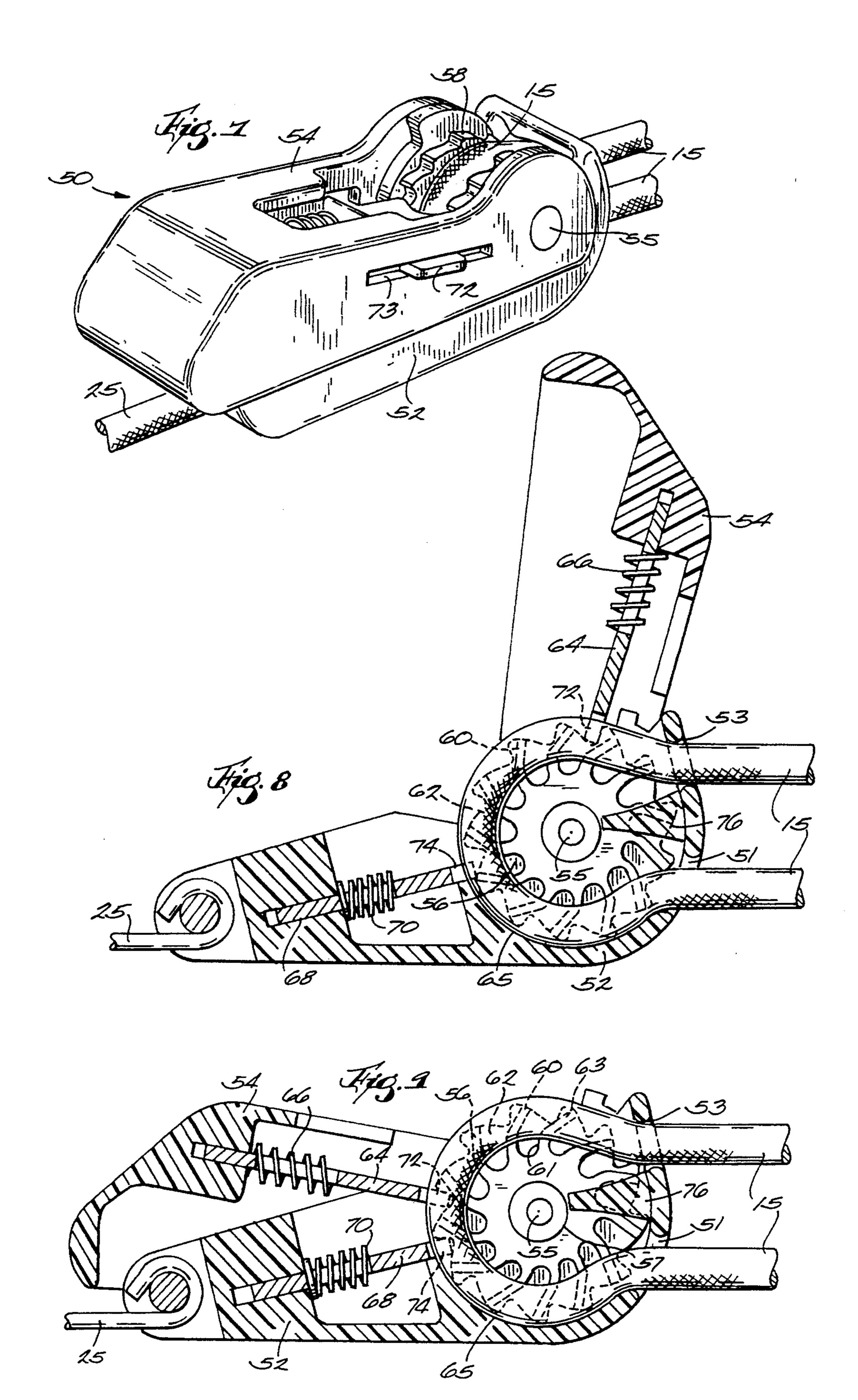
RATCHET PULLEY FOR TIGHTENING CORDS OR ROPES
