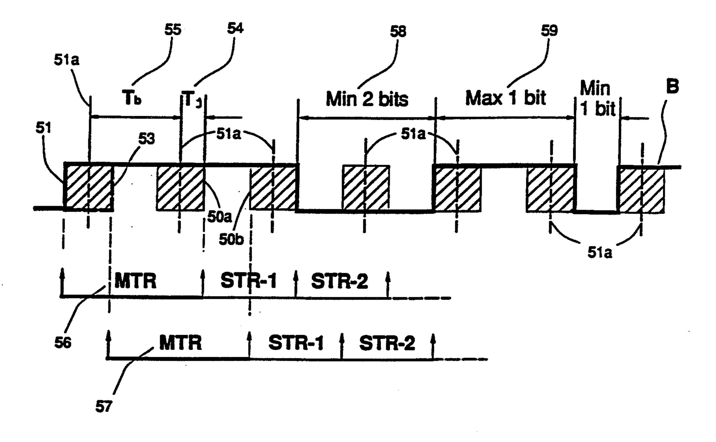
$T_{MTR} = T_b + 2 T_j$   $T_{Max 1 bit} < T_{Min 2 bits}$   $T_{STR} = T_b$   $T_b + 2T_j < 2T_b - 2T_j$   $4T_j < T_b$   $T_j < 0.25 T_b$ or  $T_j (p-p) < 50\% T_b$
