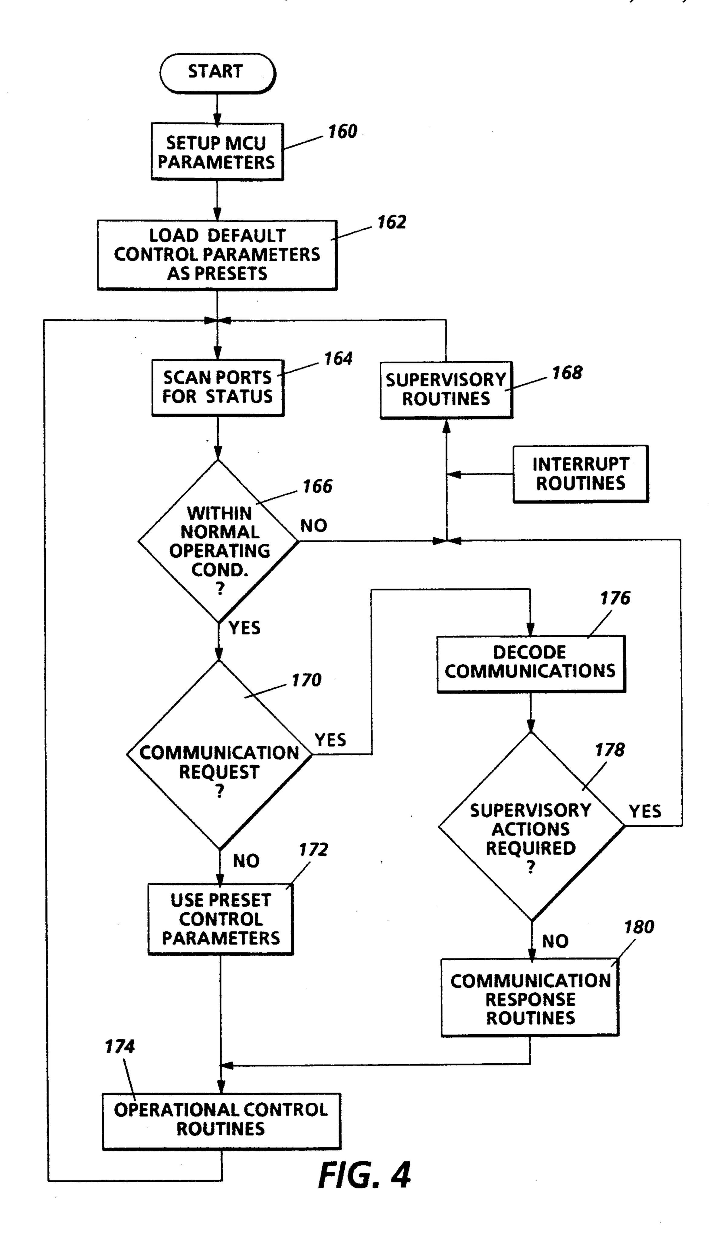
MICROCONTROLLER BASED XEROGRAPHIC CHARGE DEVICE POWER SUPPLY
