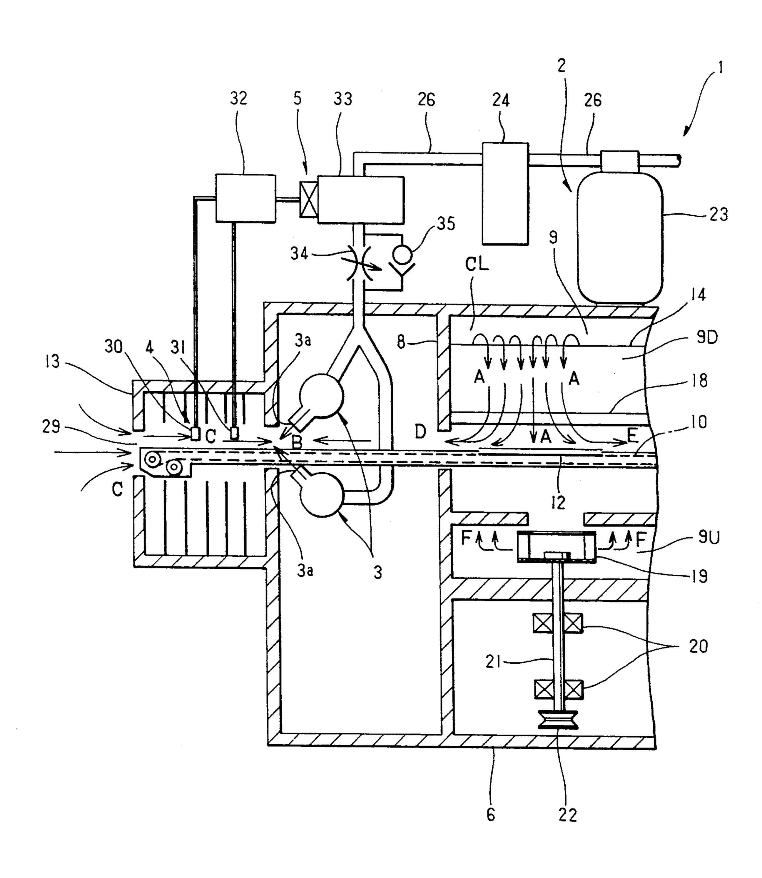
**AUTOMATIC SOLDERING APPARATUS**
