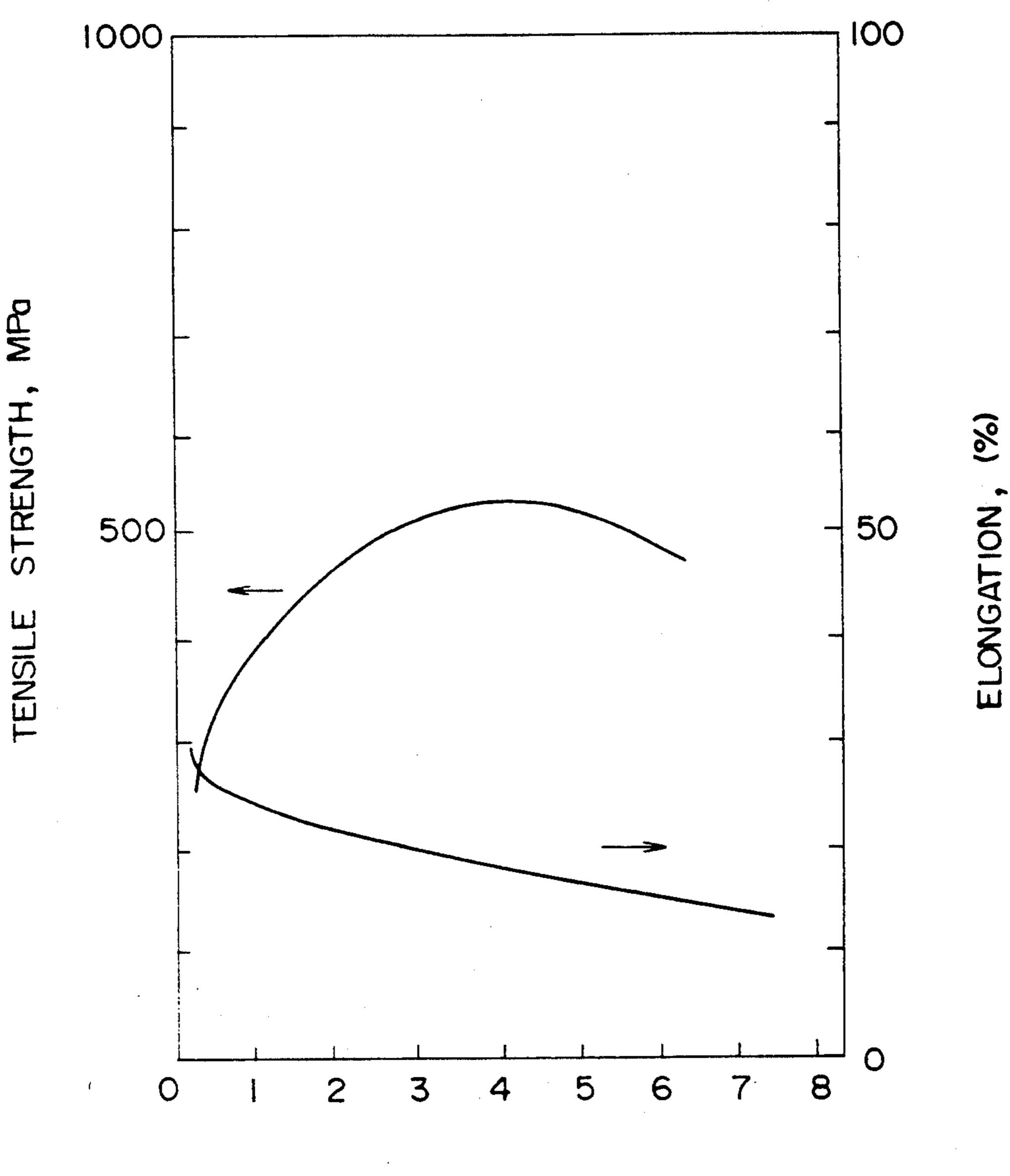
Zr CONTENT(x), at. % (Al<sub>92-X</sub> Ni<sub>8</sub> Zr<sub>X</sub>)
