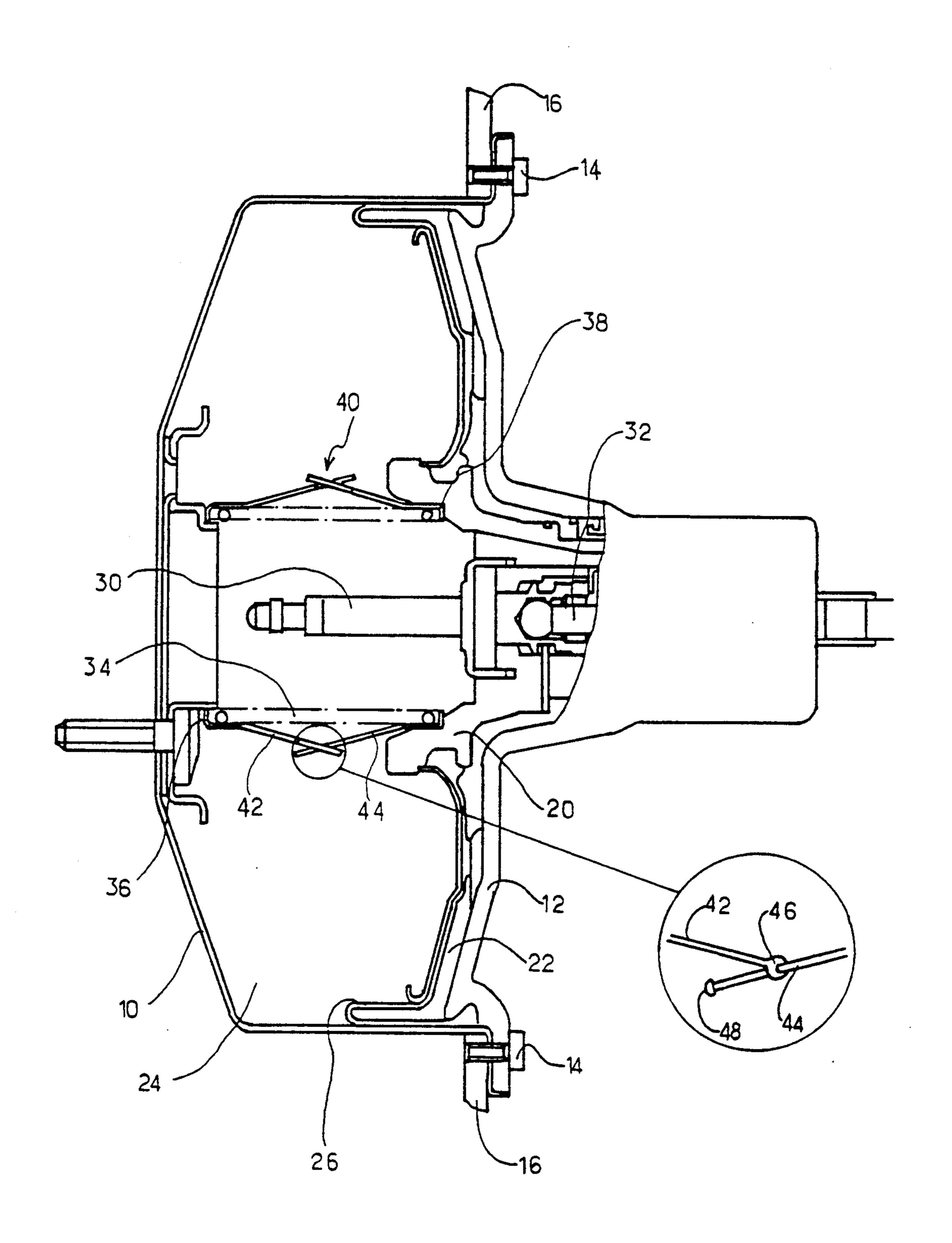
BRAKE BOOSTER WITH COMPRESSION SPRING **EXTENSION LIMITING LINKS**
