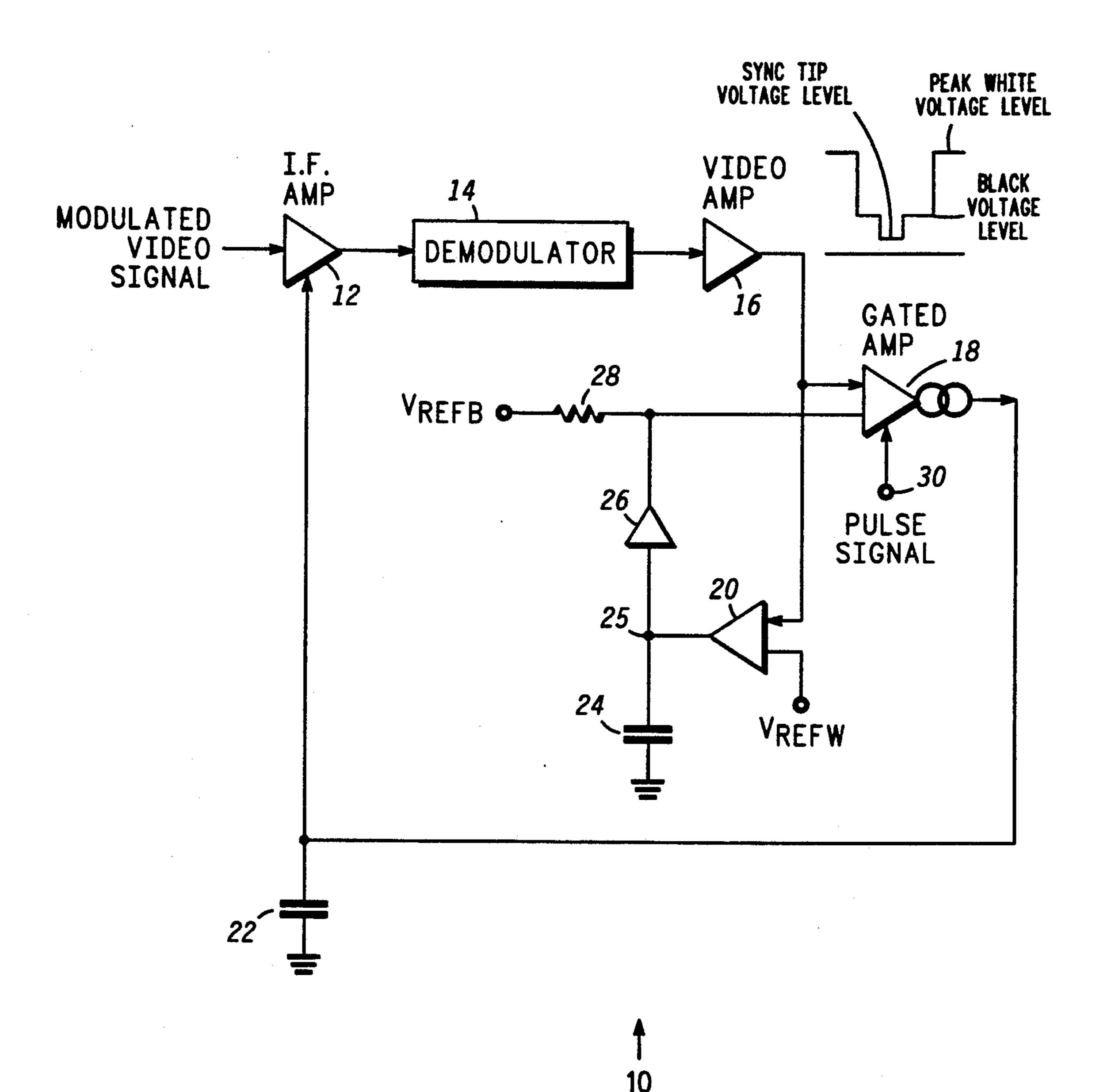
AUTOMATIC GAIN CONTROL SYSTEM FOR USE IN POSITIVE MODULATION WHICH DETECTS THE PEAK WHITE VOLTAGE LEVEL SLOWLY WHILE SIMULTANEOUSLY ADJUSTING BLACK 5 VOLTAGE LEVEL FLUCTUATIONS QUICKLY
