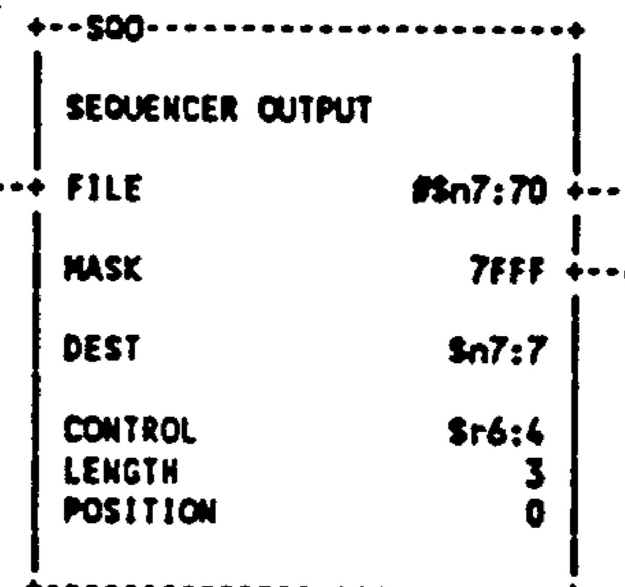
\$r006:004 ... CANISTER 4 BURNOUT DAMPER SEQUENCER
