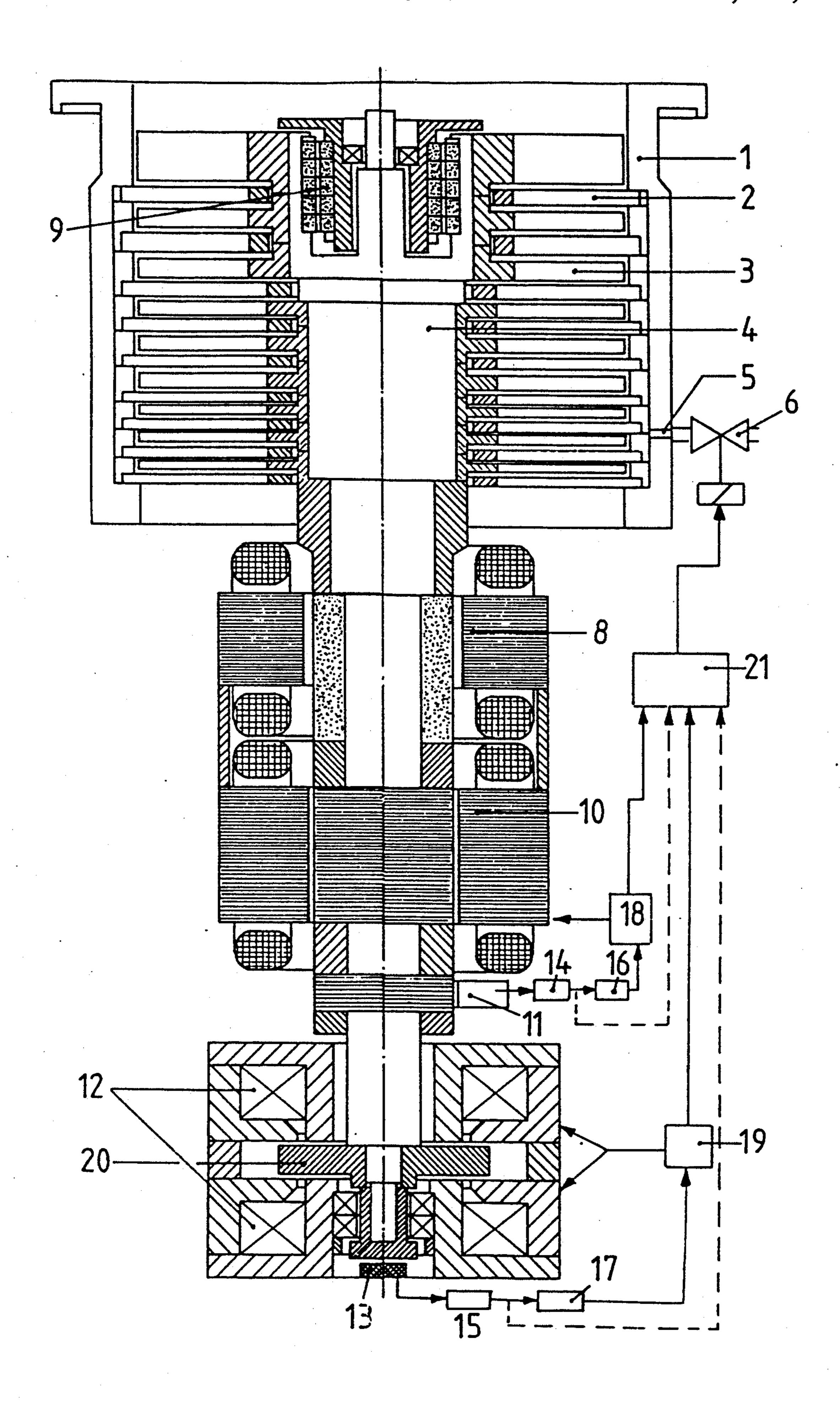
ARRANGEMENT FOR FLOODING HIGH SPEED **VACUUM PUMPS**
