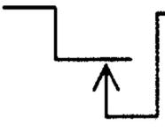
OPEN BACK CONTACT ON ENERGIZED RELAY
