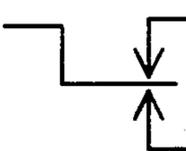
FRONT/BACK CONTACT ON ENERGIZED RELAY
