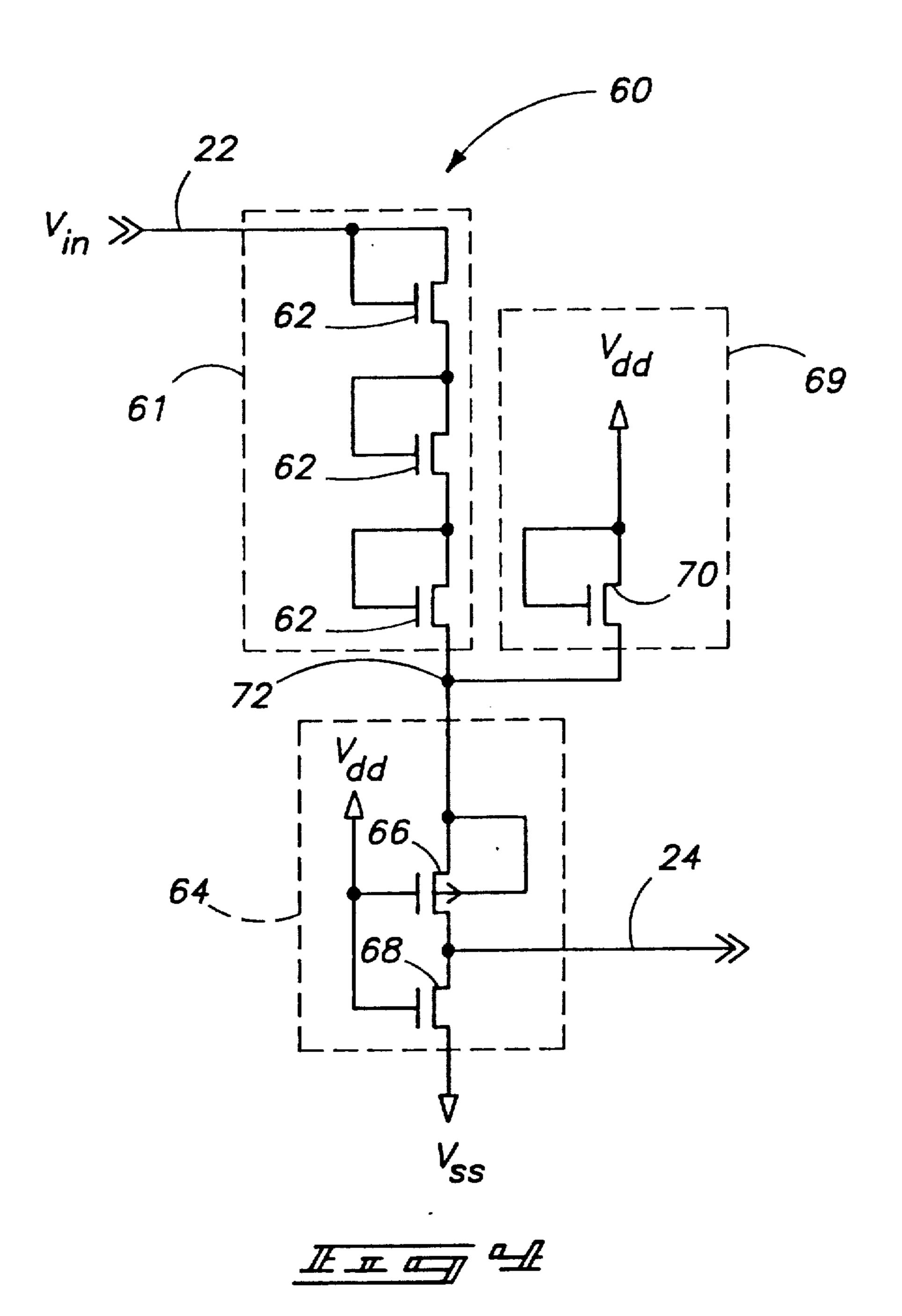
SPECIAL MODE ACTIVATION CIRCUIT FOR SELECTIVELY ACTIVATING A SPECIAL MODE CIRCUIT OF A SEMICONDUCTOR INTEGRATED CIRCUIT DEVICE
