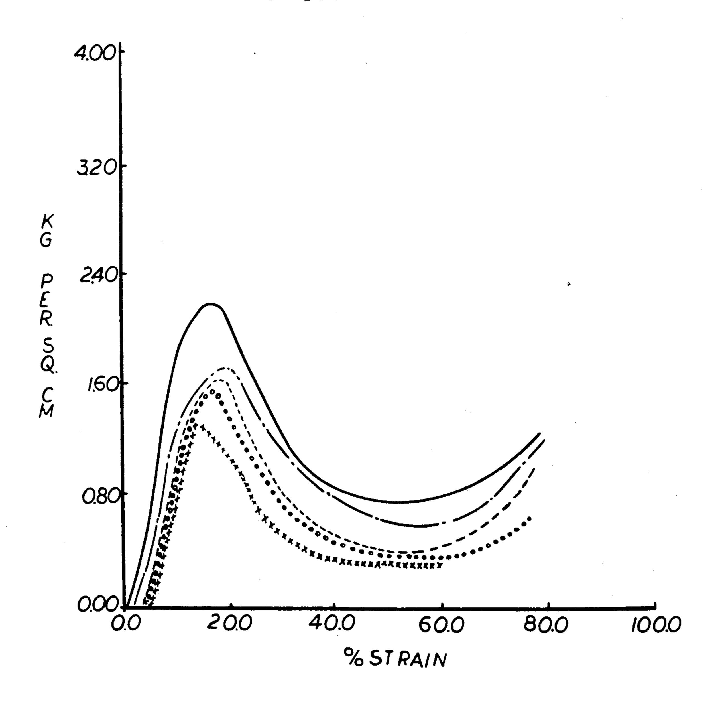
FIG.3 STRESS VS % STRAIN
