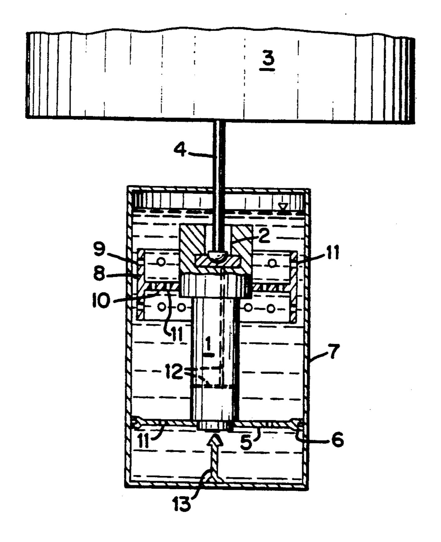
BEARING ARRANGEMENT FOR HIGH-SPEED **SHAFTS**
