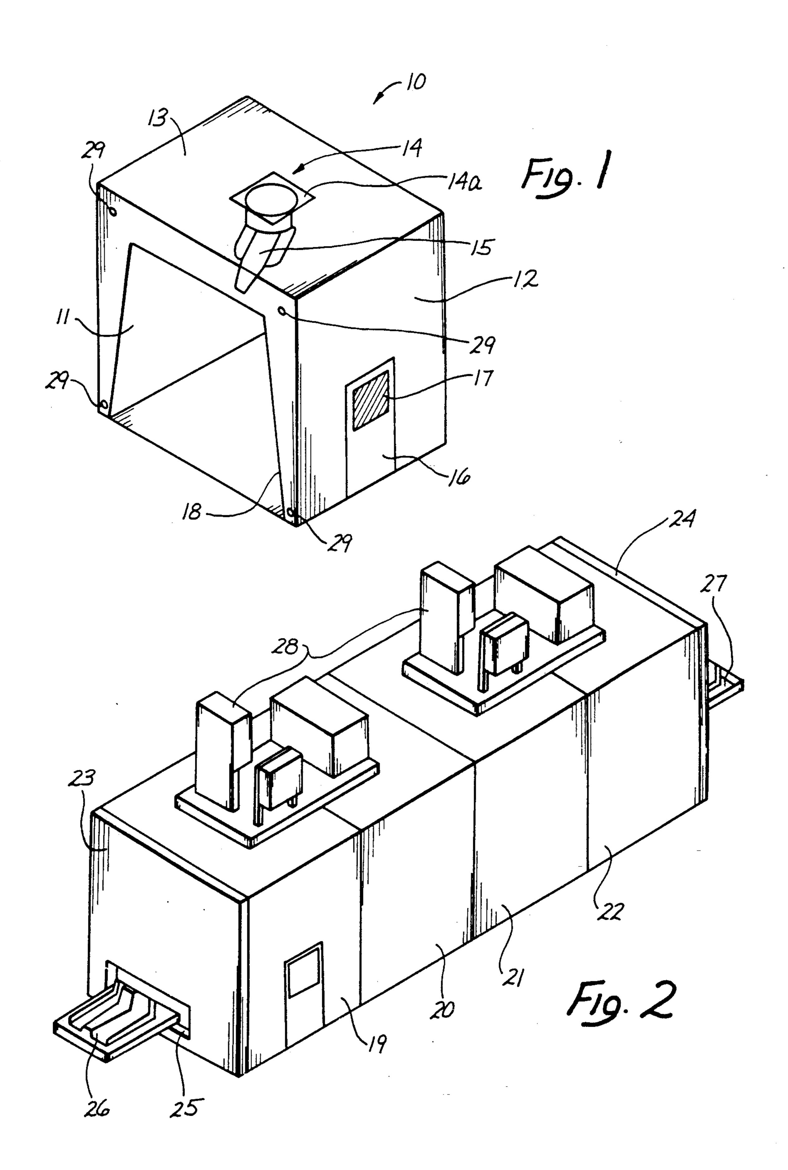
**ENCLOSURE FOR LIQUID JET CUTTER**
