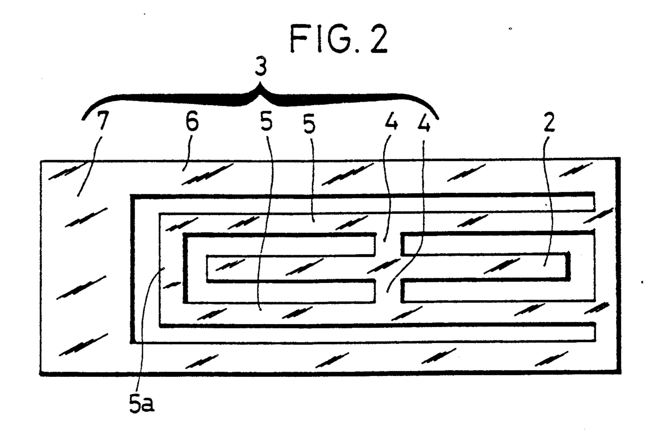
LONGITUDINAL QUARTZ CRYSTAL RESONATOR
