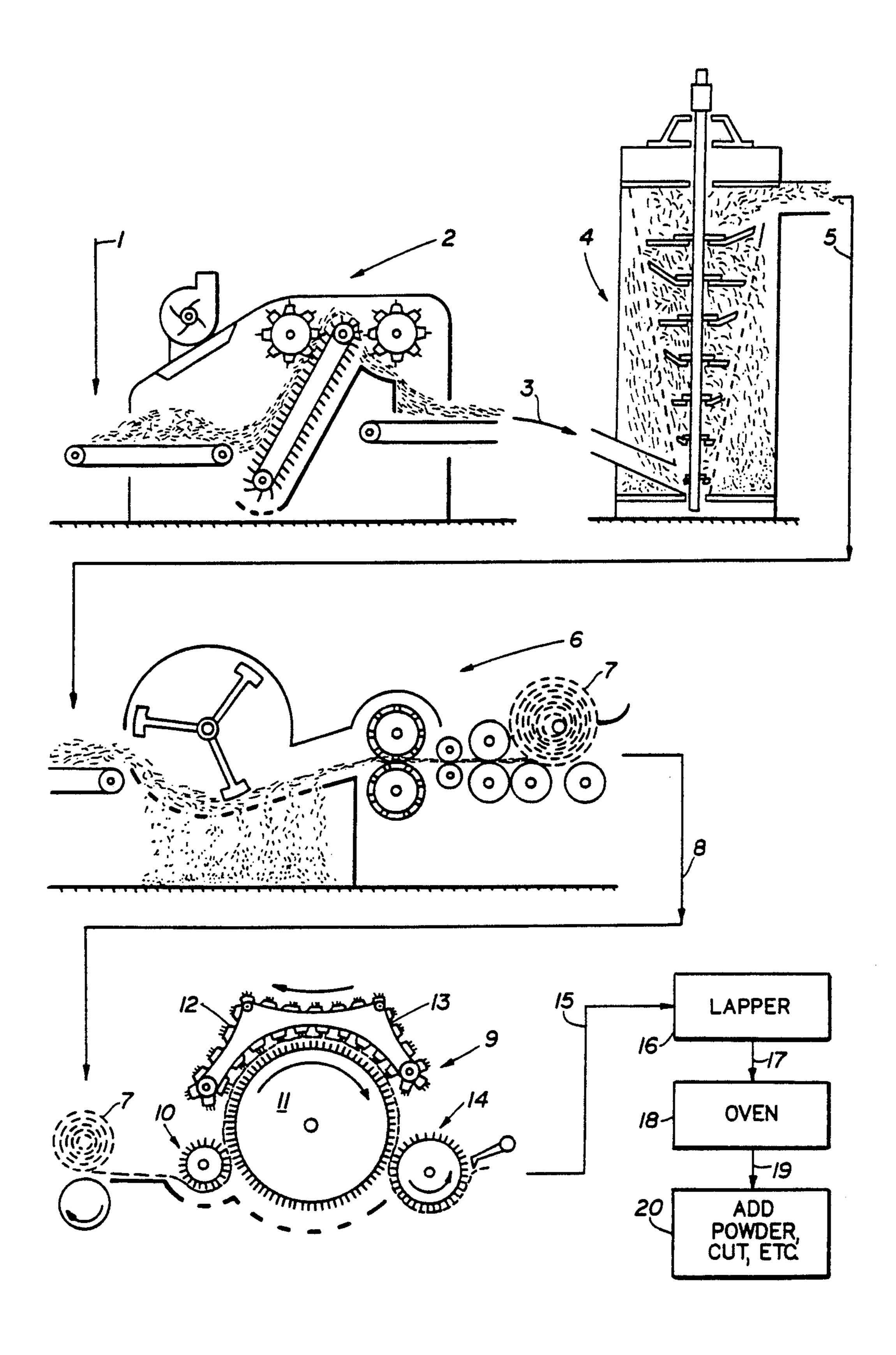
METHOD OF MAKING LOW DENSITY INSULATION COMPOSITION
