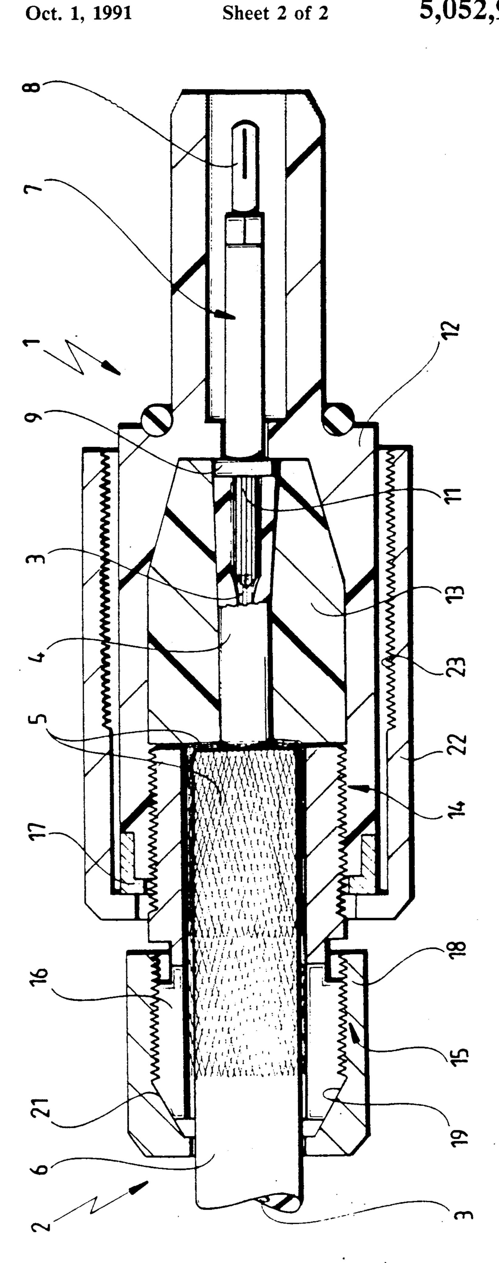
PLUG CONNECTOR FOR HIGH-VOLTAGE COAXIAL CABLES
